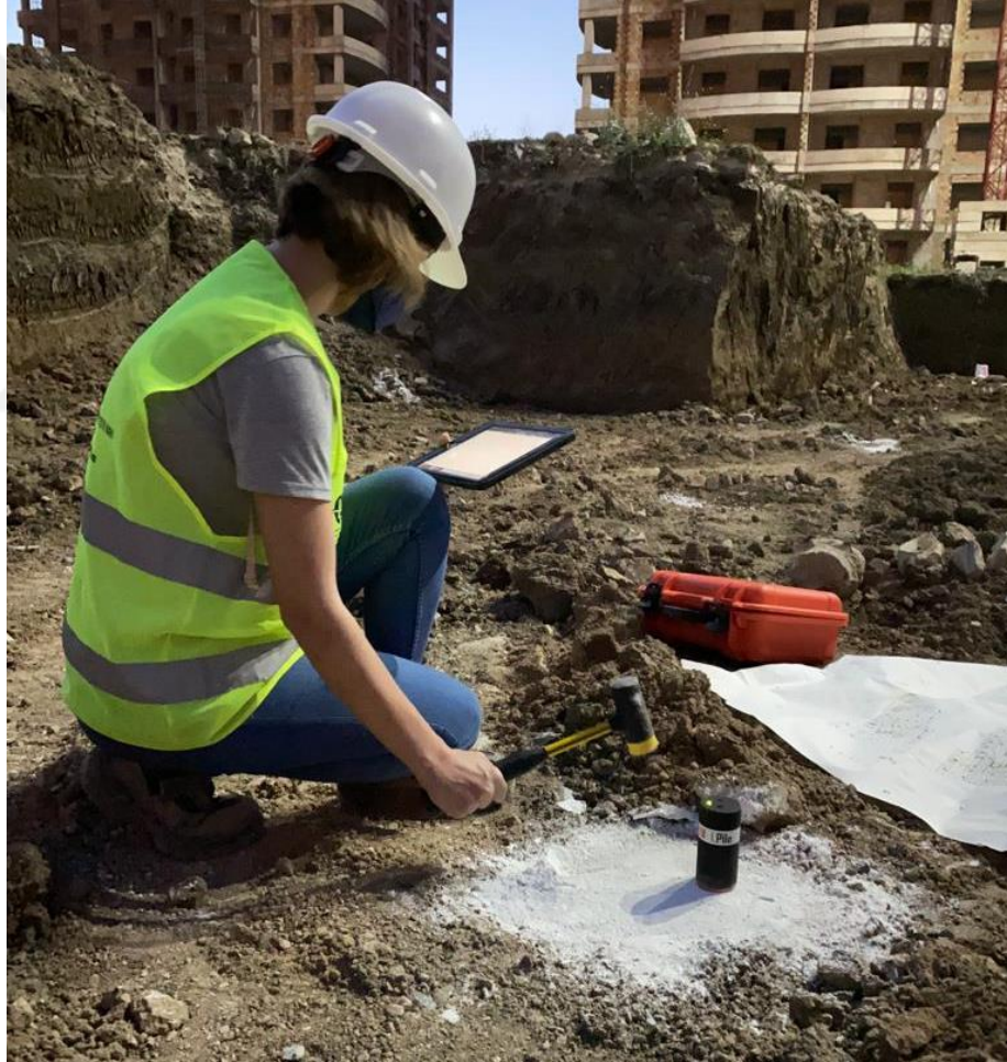
Şekil 15. Sismik Süreklilik Deneyi Saha Uygulanması
