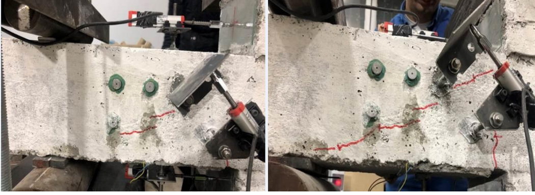
Şekil 4. 44. CCRS-R numunesinde oluşan ilk eğik kesme çatlağı
