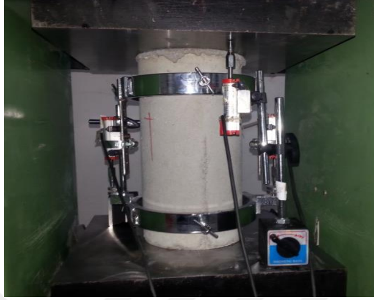
Şekil 3. 13. Standart silindir basınç deneyine ait düzenek
