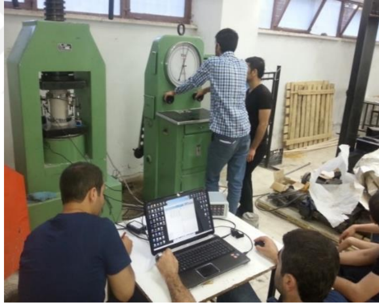
Şekil 3. 14. Standart silindir basınç deneyine ait düzenek
