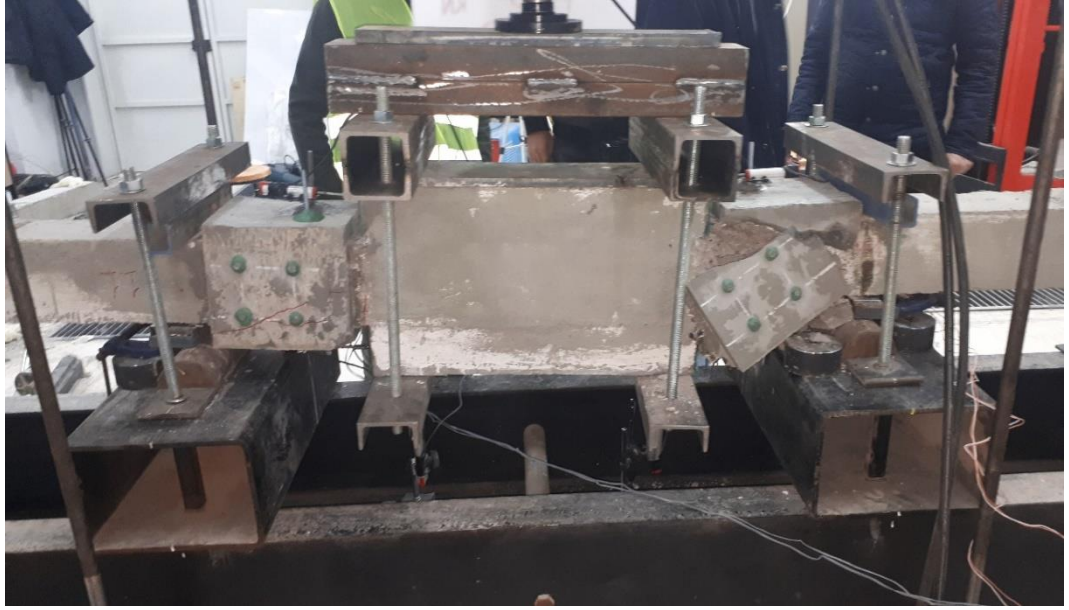
EK 3. 10. DS-R numunesi meydana gelen göçme şekli (Arka yüzden görünüm)
