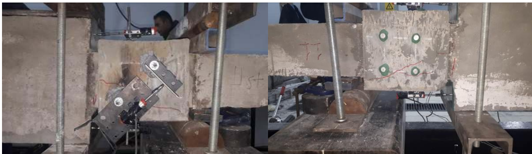
Şekil 4. 32. DS-R numunesinde oluşan ilk eğik çatlakları
