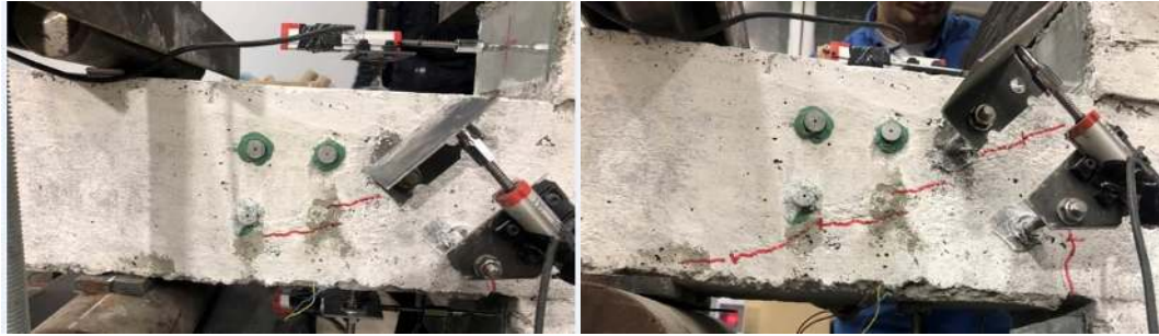
Şekil 4. 17. CCRS-O numunesinde oluşan ilk eğik kesme çatlağı
