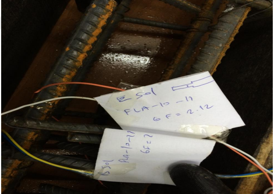
Şekil 3. 43. Donatı yüzeyine şekil değiştirme ölçerlerin isimlendirilmesi
