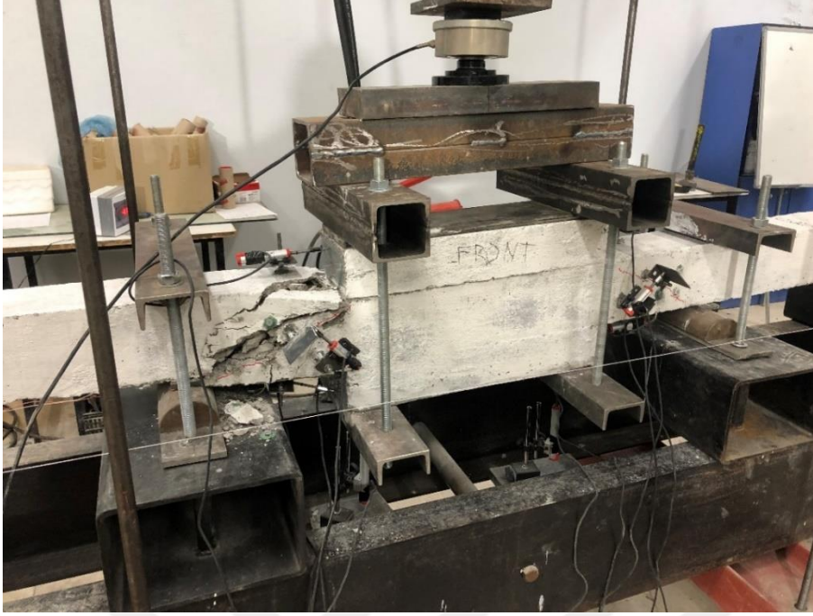
EK 3. 7. CCRS-O numunesinde kesme etkilerinden dolayı meydana gelen göçme şekli (Ön yüzden görünüm)
