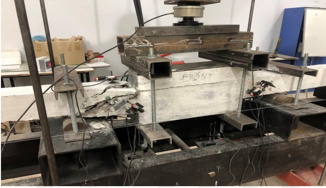
Şekil 4. 18. CCRS-O numunesinin deney sonlarına doğru hasar gelişimi
