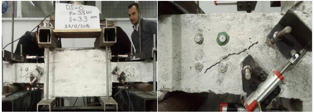
Şekil 4. 1. DS-O numunesinde oluşan ilk eğik çatlak
