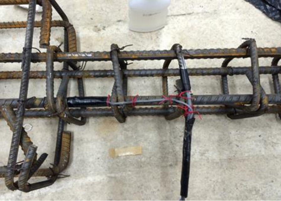
Şekil 3. 6. Şekildeğiştirmeölçerin bantlanarak dış etkenlerden korunması
