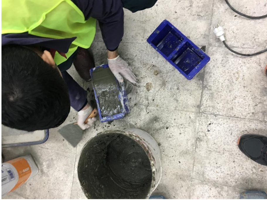
Şekil 3. 33. Standart küp deney numuneleri için yapısal tamir harcından küp numune alınması
