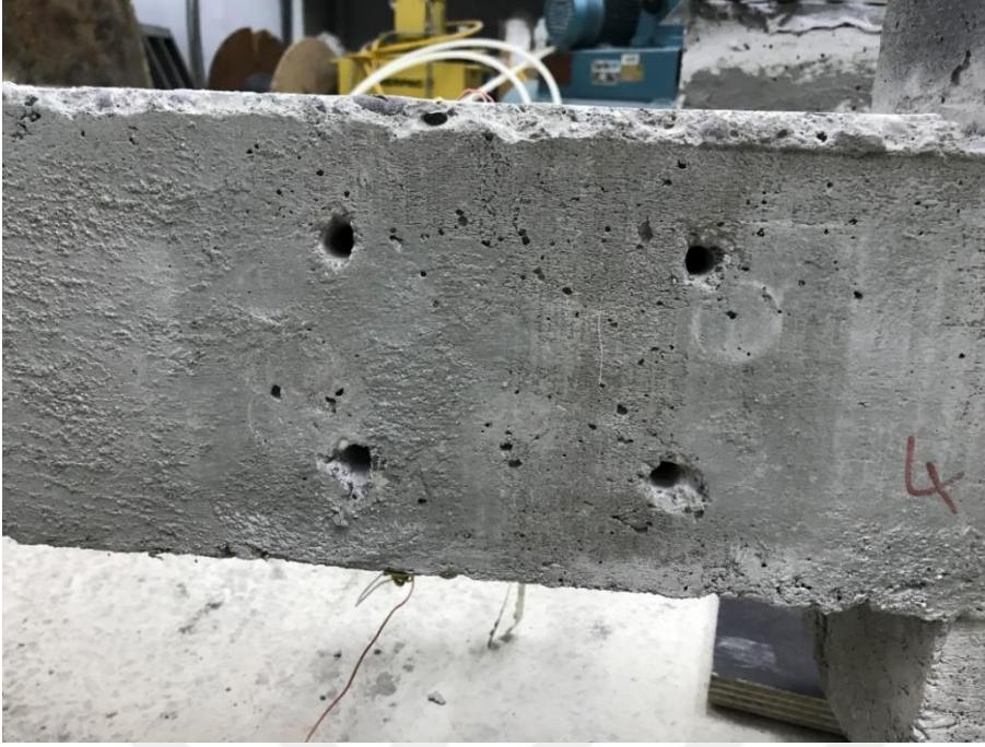
Şekil 3. 27. Ankraj deliklerinin açılması
