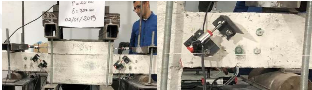
Şekil 4. 16. CCRS-O numunesinde oluşan ilk eğilme çatlağı
