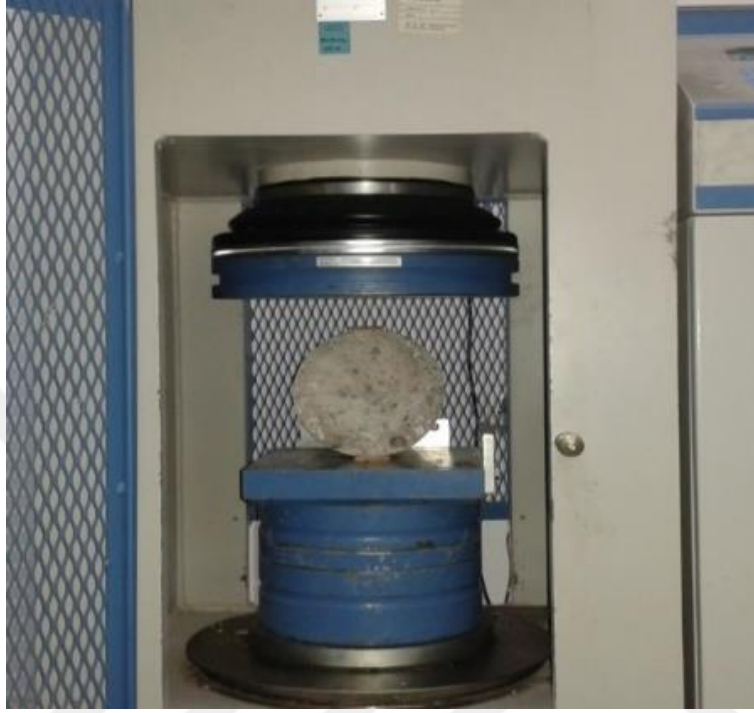
Şekil 3. 17. Disk yarma deneyi için düzenek
