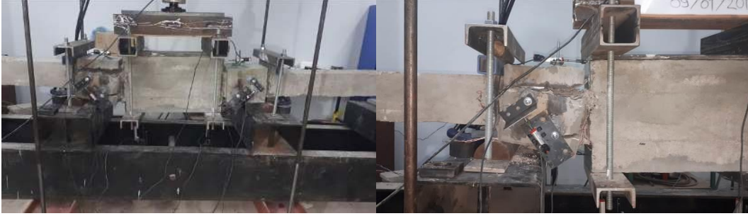
Şekil 4. 33. DS-R numunesinin deney sonlarına doğru hasar gelişimi
