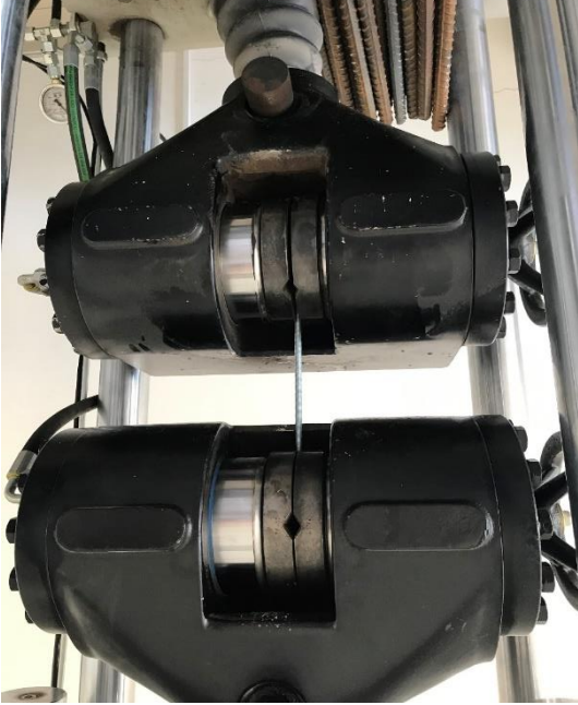
Şekil 3. 19. Çelik levha ankrajlanmasında kullanılan tij çekme deneyi
