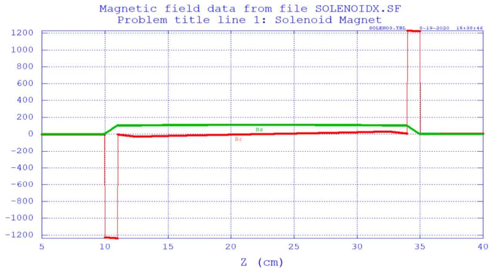
Şekil 3.10. Sarmal mıknatısın manyetik alan dağılımının Bx ve By bileşenlerinin konuma (Z) bağlı grafiği
