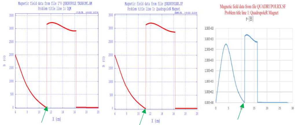
Şekil 4.71. 1/8'lik normal dört kutuplu tasarımın (solda) ve normal dört kutuplu tasarımın (ortada) x-|B| bağlı manyetik alan dağılımı grafikleri ile Excel dosyasında oluşturulan hipotenüs üzerindeki manyetik alan dağılımını veren döndürülmüş dört kutuplu tasarımın r-|B| bağlı manyetik alan dağılım grafiği (sağda) demirle kesildiği bölgedeki değerlerin karşılaştırılması
