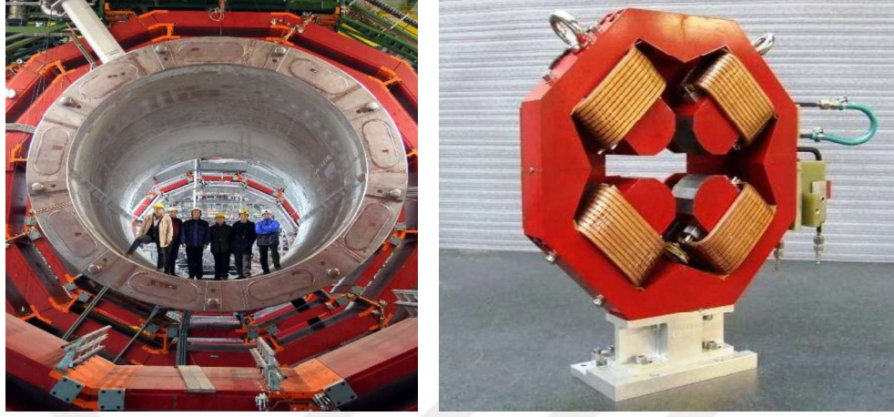
Şekil 1.3. Sarmal mıknatıs (solda), dört kutuplu mıknatıs (sağda)
