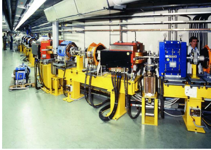
Şekil 1.5. Yay üzerindeki mıknatıslar, kırmızılar: bükme mıknatısları; maviler: dört kutuplu; sarı rekli olanları ise altı kutuplu mıknatıslardır. Yay üzerindeki beyaz dikey ve yatay tüpler ışığı eş zamanlayıcı radyasyon monitörüne yönlendirir
