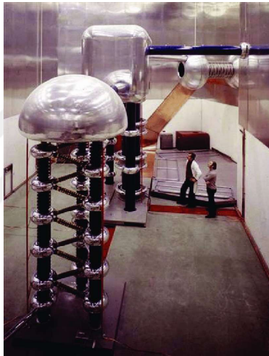
Şekil 1.1. Linak 2750 keV Cockcroft-Walton jeneratör kaynak ve hızlandırıcı sistemi
