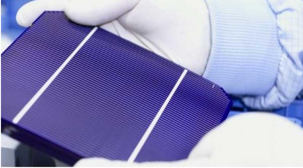
Şekil 2. 9. Tek kristalli (monokristal) güneş hücresi [8]
