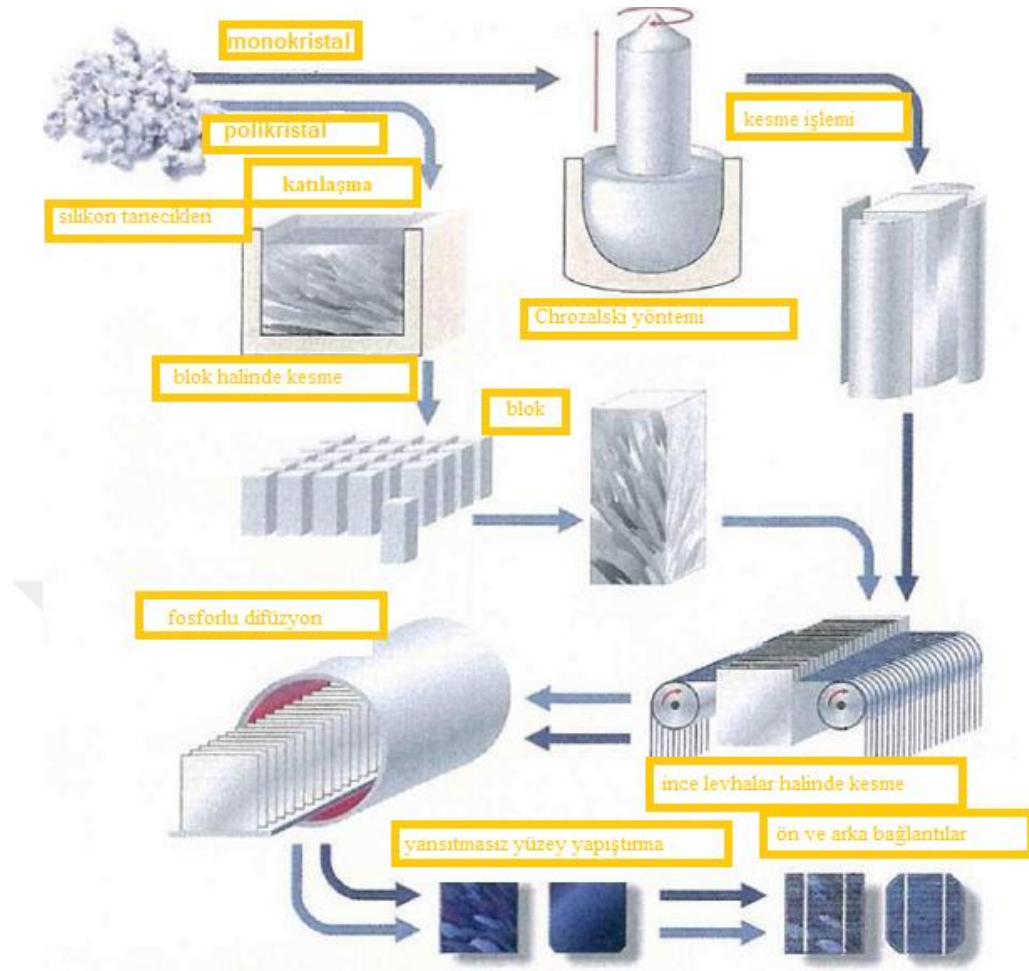
Şekil 2. 10. Tek ve çok kristal hücrelerinin kesme ve çekme yöntemi [10]
