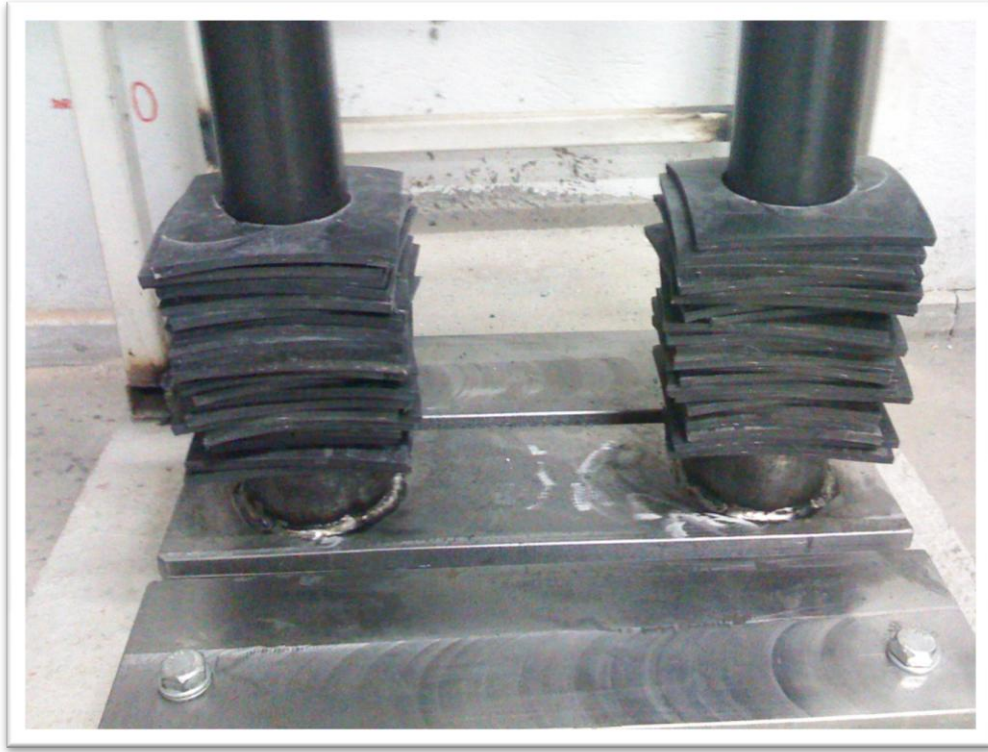
Resim 8.12. Kızaklar etrafındaki sönümleyici pedler [27]
