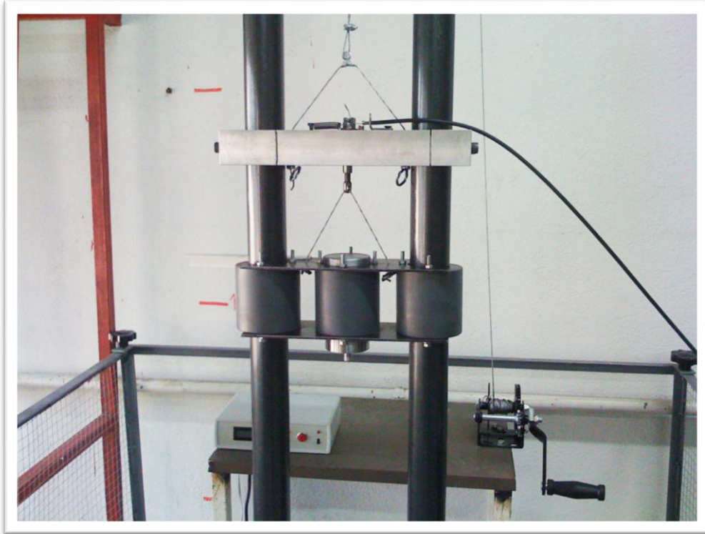
Resim 8.15. Serbest bırakma mekanizmasının diğer bir görünüşü [27]
