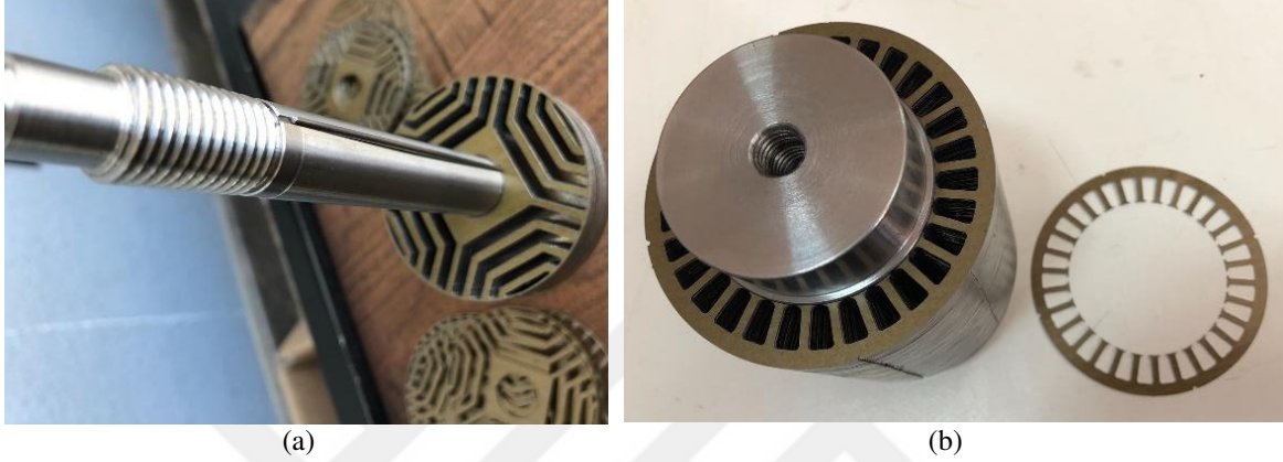
Şekil 3.17 a) Rotor ve mil üretimi, b) Stator paketinin üretimi
