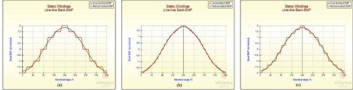
Şekil 3.1 Stator zıt-EMK sinyalleri; a) 24 oluk, b) 30 oluk, c) 36 oluk
