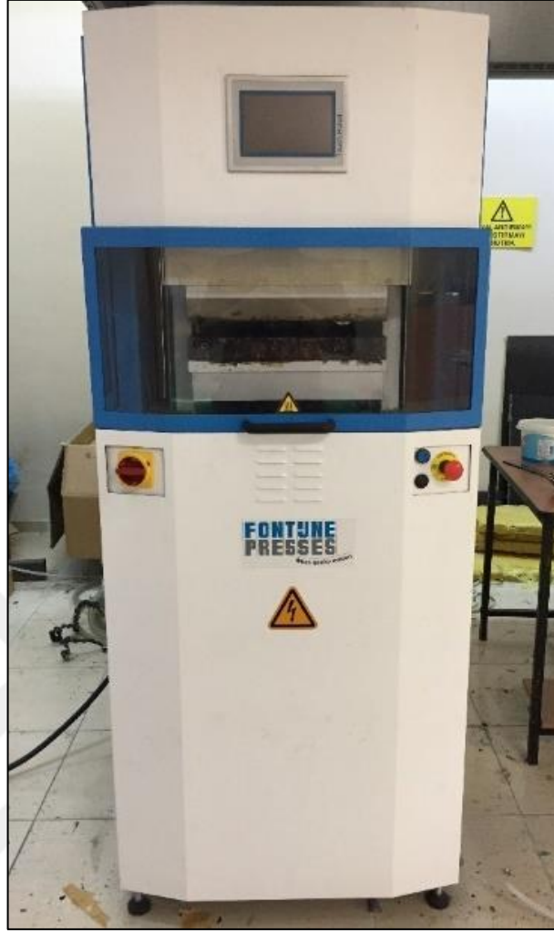
Şekil 4.1 Numune üretiminde kullanılan Fontijne markasının LabEcon 600 serisine ait pres cihazı (Kişisel arşiv, 2019)
