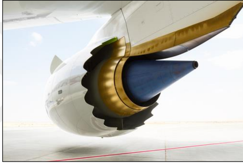
Şekil 2.7 Boeing Dreamliner Firması için seramik matrisli kompozitlerden yapılmış GENx jet motoru (Ge, 2015)
