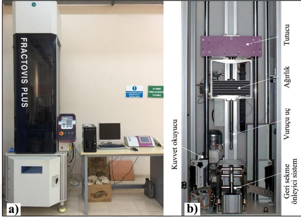
Şekil 4.2 CEAST Fractovis Plus darbe cihazı a) dış gösterim ve b) iç gösterim (Kişisel arşiv, 2019)
