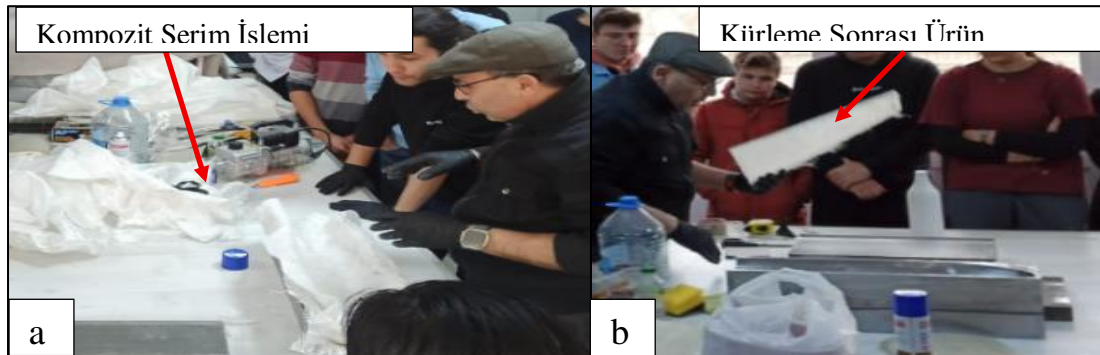
Şekil 5.6. Vakum İnfüzyon Yöntemi ile Kompozit Kanat Üretim Süreci
