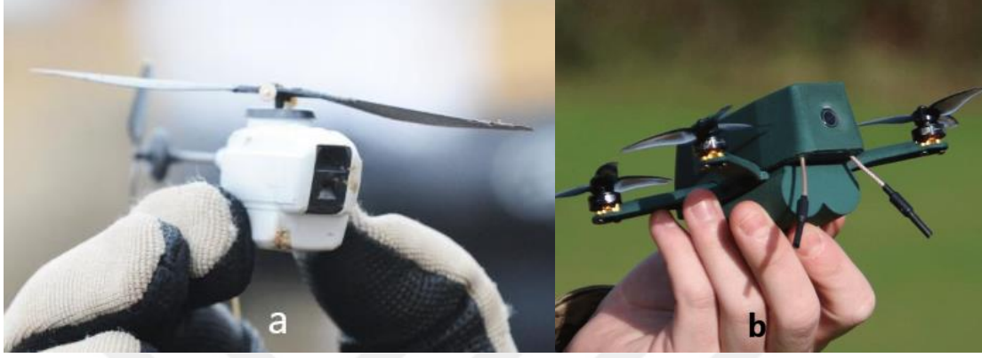
Şekil 1.9. (a) 33 gr Blak Hornet 3, (b) 196 gr Bug İsimli Nano İHA'lar
