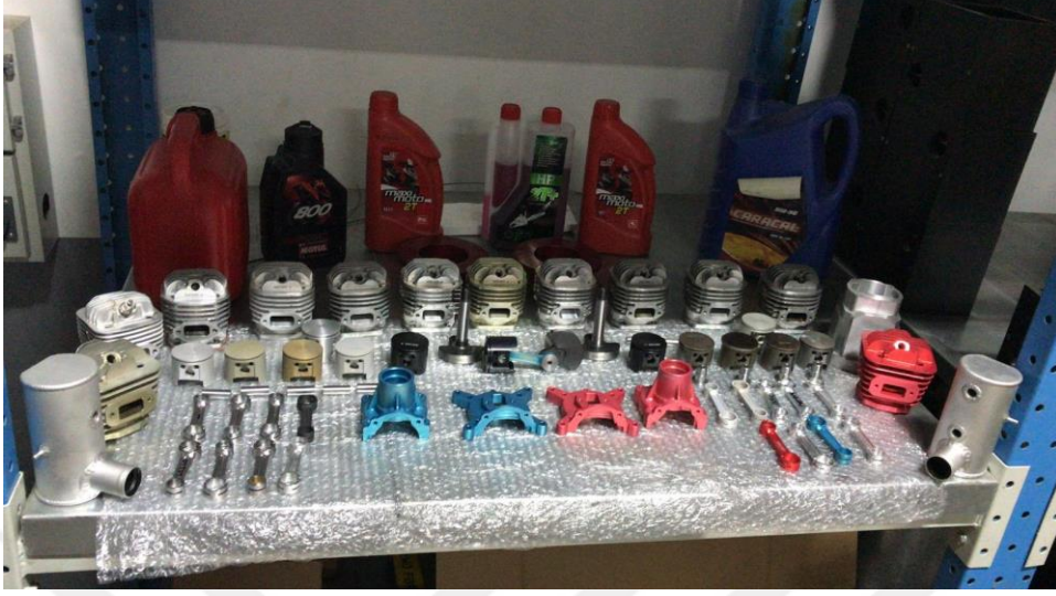
Şekil 5.7. Yerli İmkanlar İle Üretilen 61 cc AHİ Motor Parçaları.
