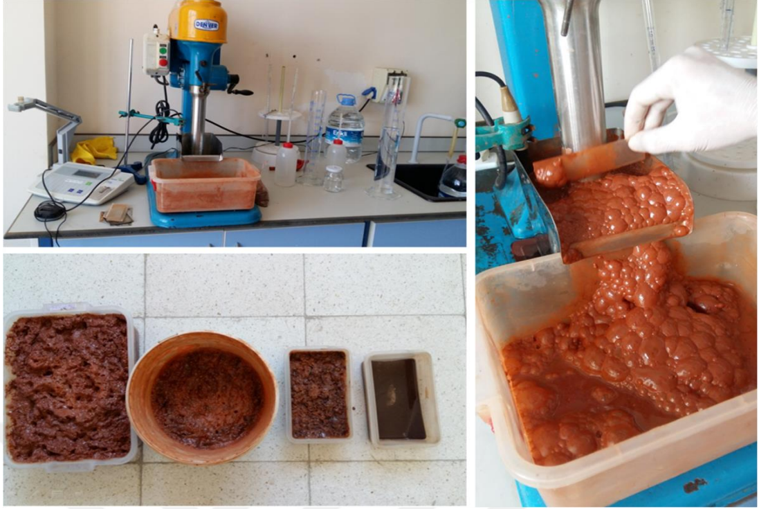
Şekil 3.7. Flotasyon deney düzeneği ve flotasyon ürünleri
