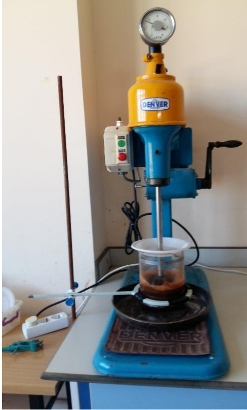
Şekil 3.5. Aşındırmalı-yıkama deney düzeneği ve aşındırma koşulları
