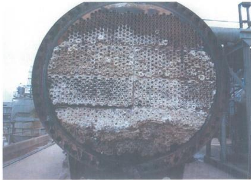
Şekil 2.7. Isı eşanjörünün duvarlarında meydana gelen kabuklaşma (Armstrong vd., 1999)
