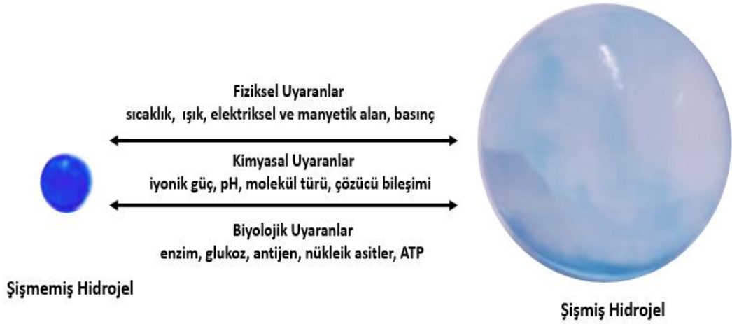
Şekil 3.6. Çeşitli uyarılara karşı şişme / büzülme davranışı sergileyen hidrojel örneği [103]
