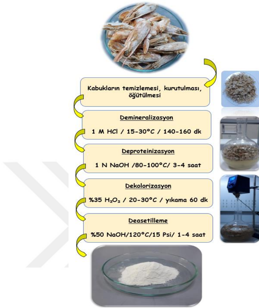
Şekil 2.3. Kimyasal yöntemle kitosan polimerinin eldesinde kullanılan optimum işlem koşulları
