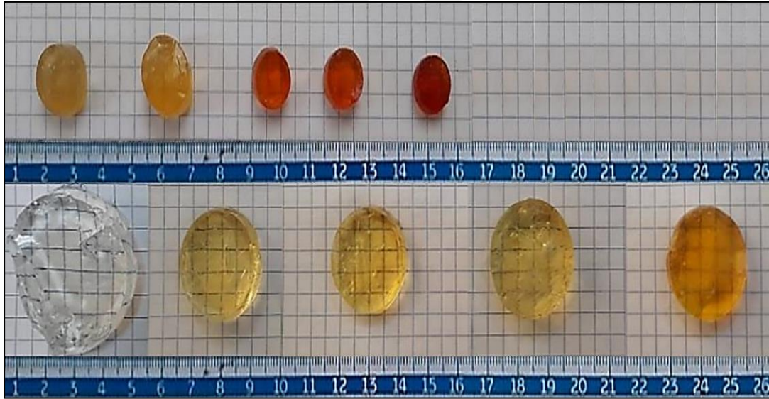
Şekil 6.18. Kitosan hidrojenlerin şişme öncesi ve sonrası görüntüleri
