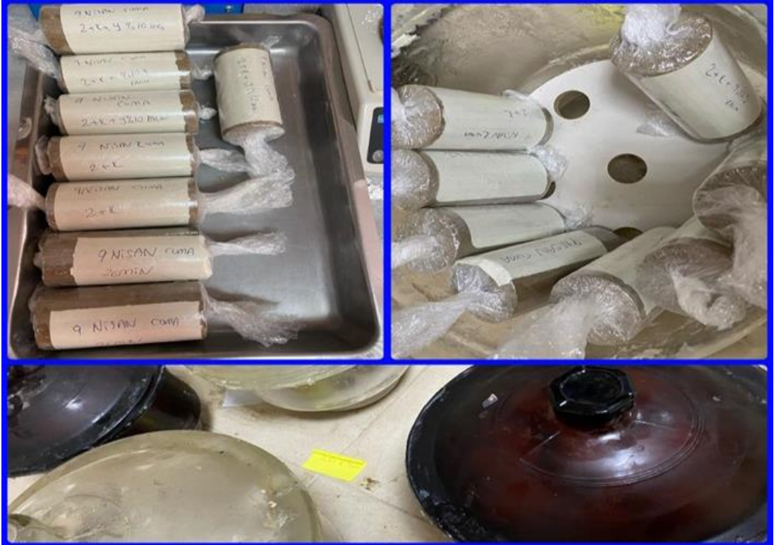
Şekil 9. Serbest basınç deneyi için hazırlanan numunelerin küre konulması.
