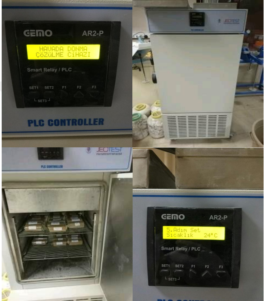
Şekil 3.10 Havada donma-çözülme cihazı ve donma-çözülme deney düzeneği
