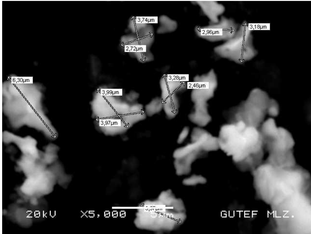
Resim 4.4. 450-8 numunesinin 5000 büyütme ile çekilmiş SEM görüntüsü
