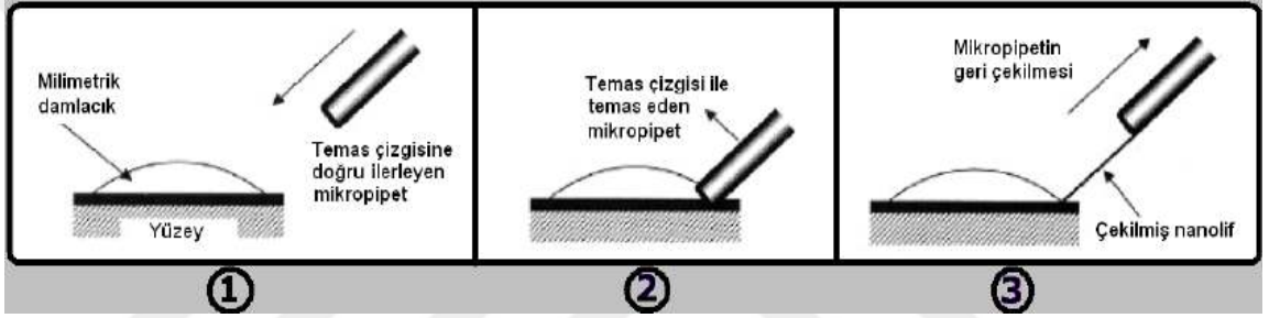
Şekil 1.13 Çekme yöntemiyle nanolif üretimi [15]
