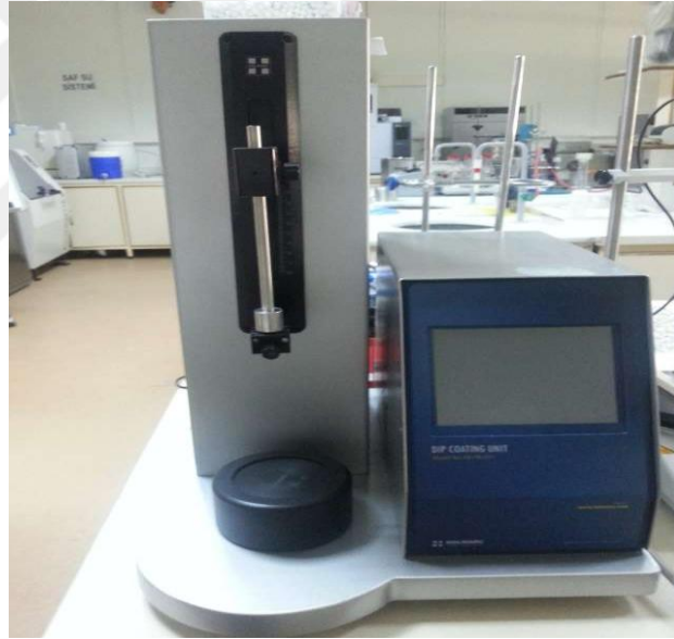
Şekil 3.2 Nanolifli yüzeylerin daldırarak kaplama yönteminin yapıldığı cihaz
