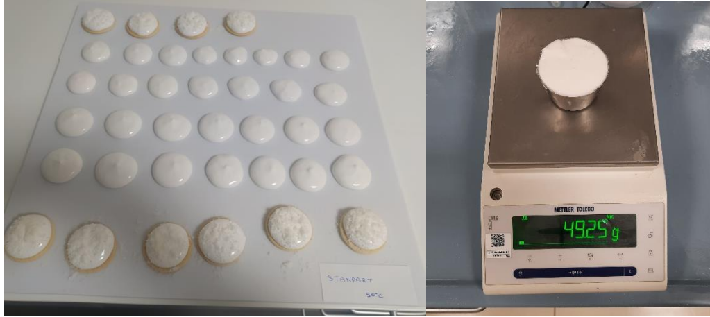
Şekil 3.3 Depozit edilmiş referans marshmallow örneği ve yoğunluk ölçümü
