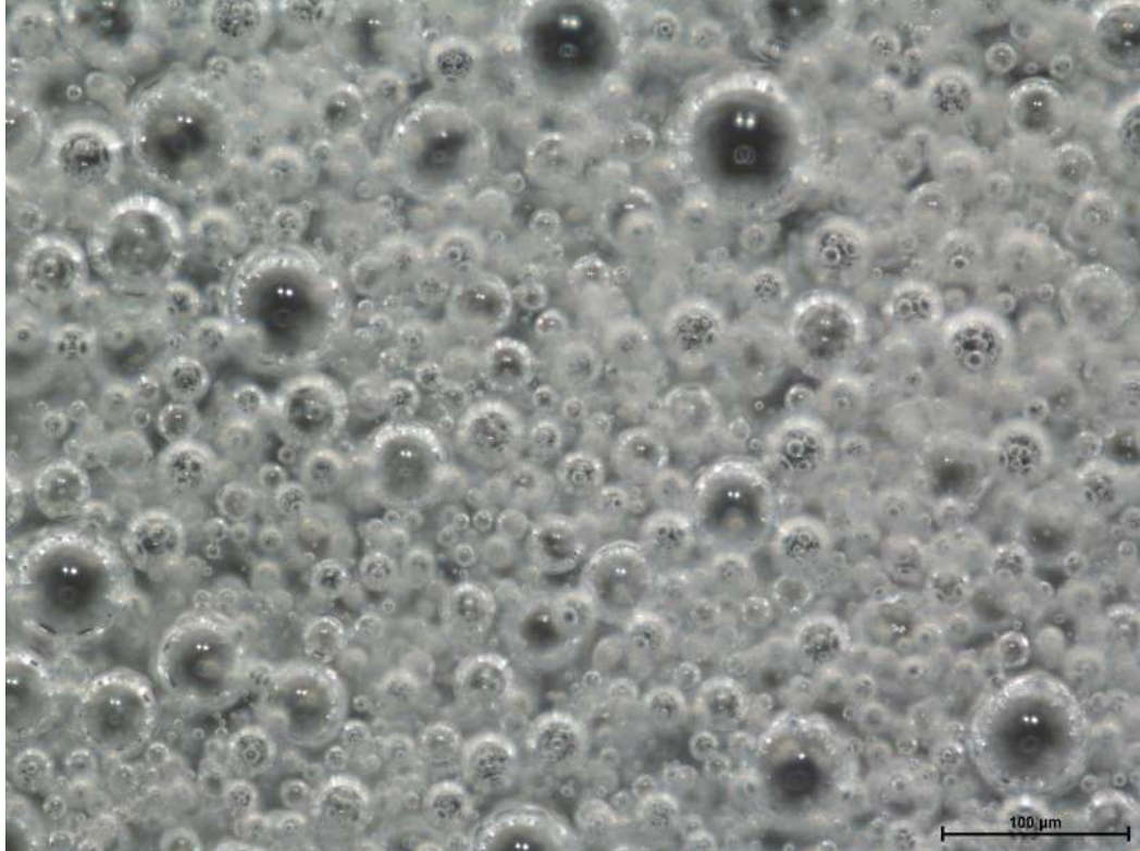
Şekil 4.8 Kontrol örneği mikroyapısı (200x)
