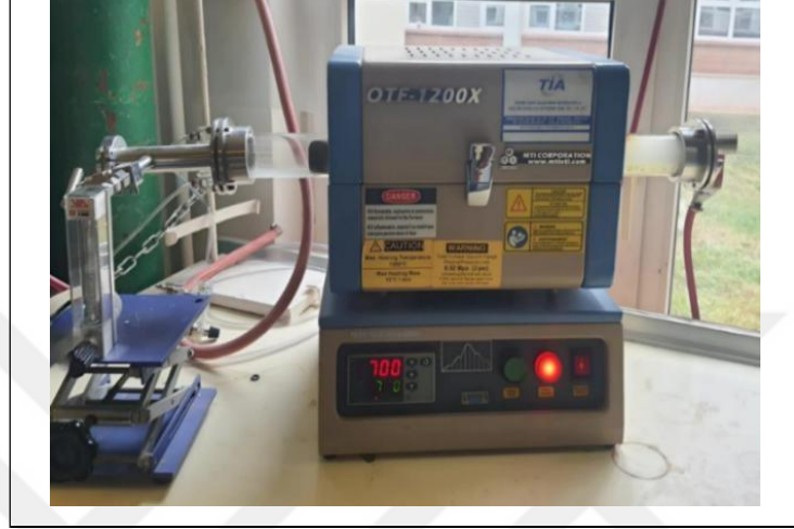
Şekil 3.2. OTF-1200X model yatay kuvars reaktör sistemi
