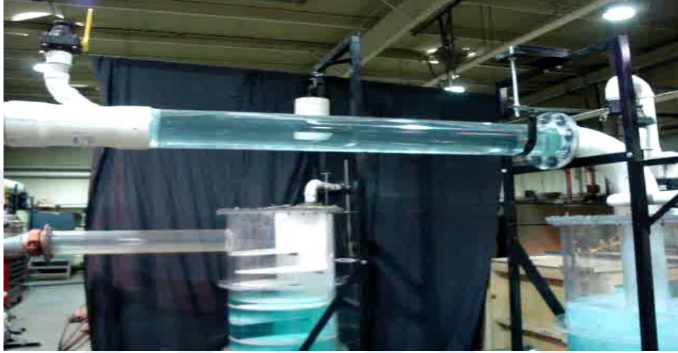
Şekil 2.5. Dalma tipi düşü yapısının genel görünümü (Margevicius, 2018)
