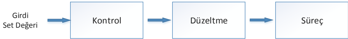
Şekil 2.16. Açık çevrim kontrol sistemi temel elemanları
