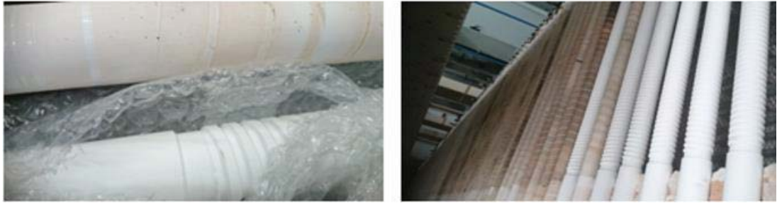
Şekil 4.10. Yivli Seramik Merdanelerin Fırın İçindeki Görünümü.
