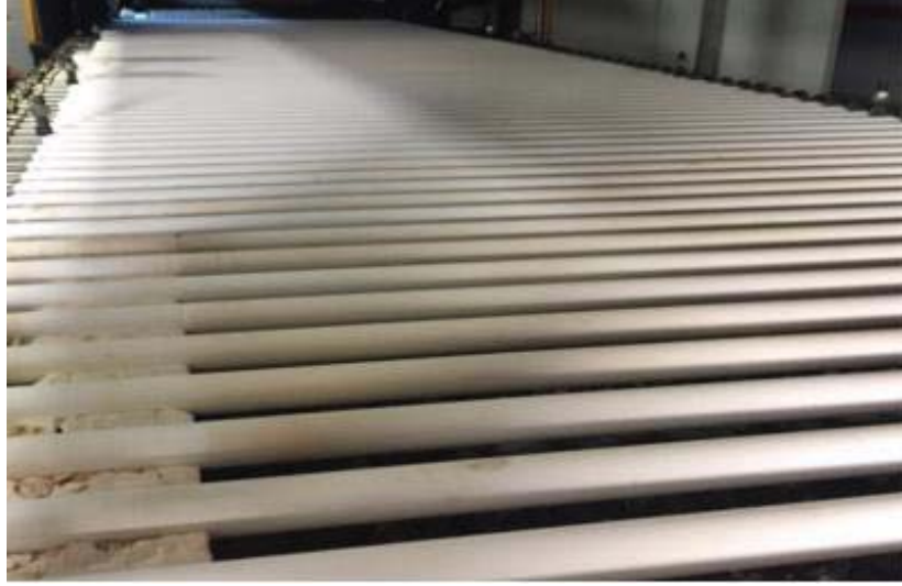
Şekil 4.9. Düz Seramik Merdanelerin Fırın İçindeki Görünümü.
