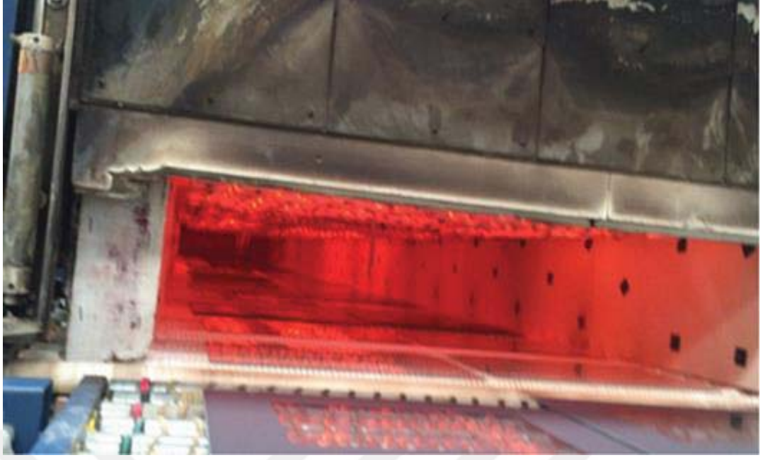
Şekil 4.2. Temper Fırınında Camların Isıtılması Görünümü.
