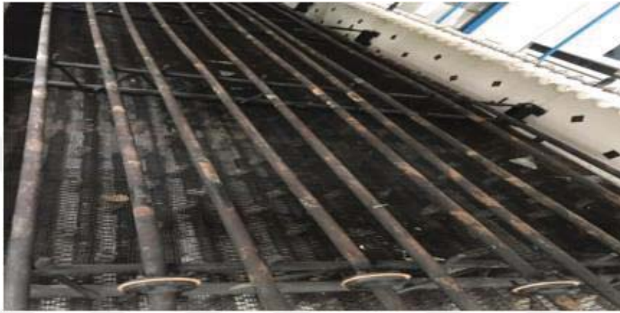
Şekil 4.4. Fırın Alt Air Convection Sistemi.
