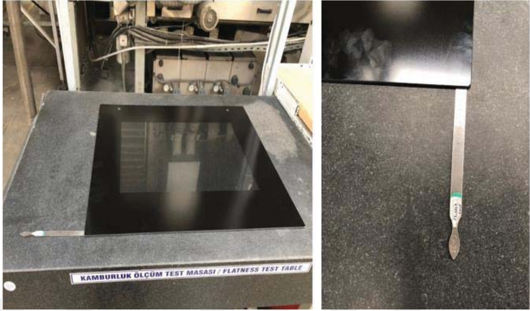
Şekil 4.19. Kamburluk Ölçüm Görünümü.
