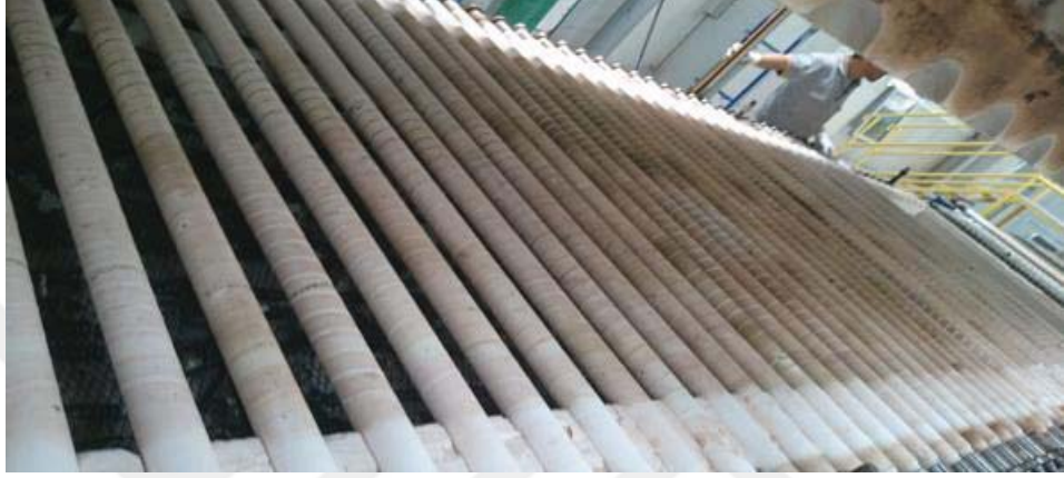
Şekil 4.8. Seramik Merdanelerin Fırın İçindeki Görünümü.
