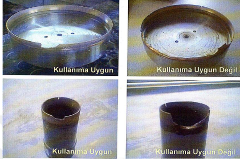
Şekil 4.1.5.3. Kırık matkap ucu örnekleri
