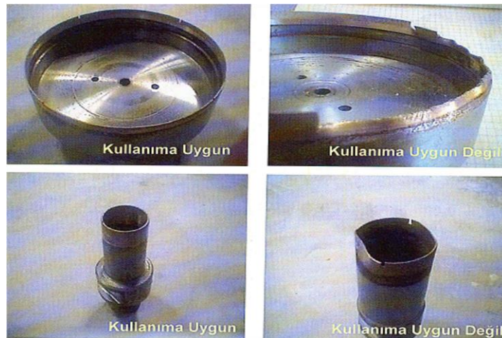
Şekil 4.1.5.2. Hasarlı matkap ucu örnekleri
