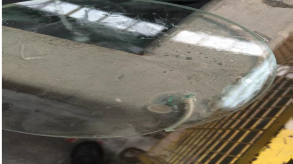
Şekil 5.1.7. Yüksek basınçlı su ve kum ile kesilmiş cam
