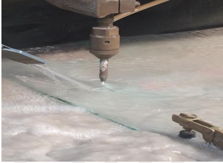
Şekil 5.1.6. Yüksek basınçlı su ve kum ile camın delinmesi
