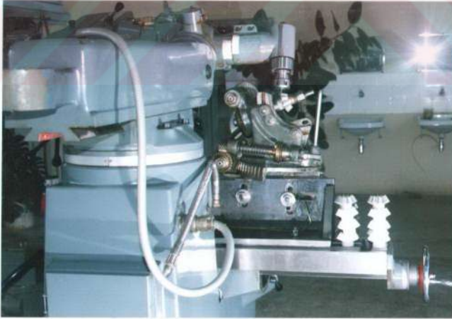
Şekil 4.5. Sol profil için tezgah kafasının \alpha_0 açısına göre ayarlanması.
