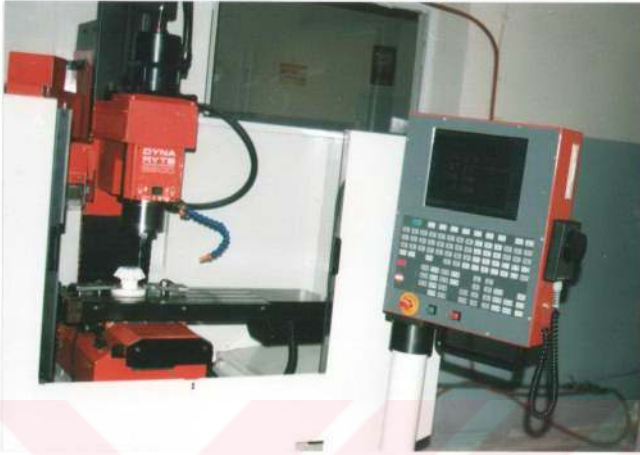
Şekil 4.25. Konik düz dişli taslağının CNC freze tezgahına bağlanması.
