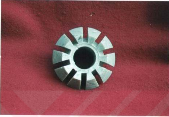
Şekil 4.4. Dış kanallarının parmak freze çakıstı ile ilk açılışı.
