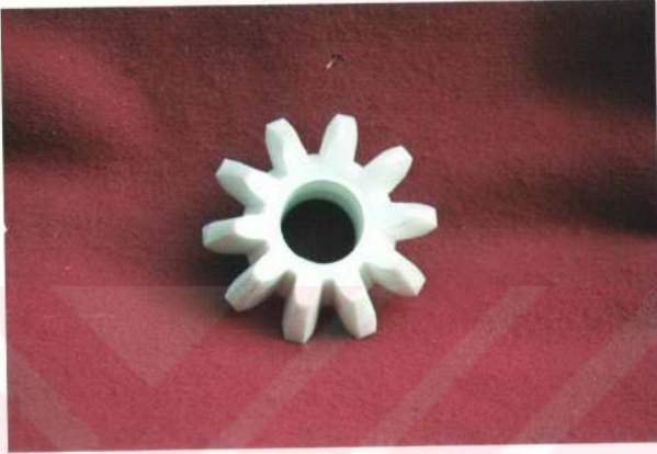
Şekil 4.9. İmalatı Parmak freze çakısı ile tamamlanmış bir konik dişli.
