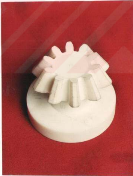
Şekil 4.26. CNC freze tezgahında genel imalat programı kullanılarak tamamlanmış bir konik düz dişli.
