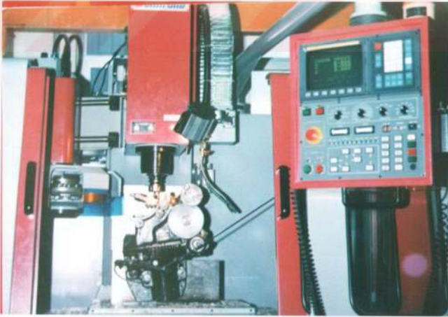
Şekil 4.10. Matterson aparatının fanuk CNC freze tezgahına bağlanması.
