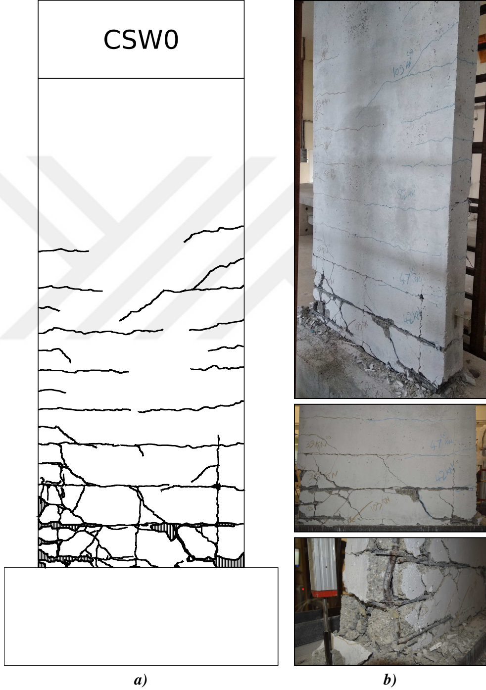
Şekil 4.2. a) Referans deney numunesinin a) hasarın şematik gösterimi ve b) örnekleri
