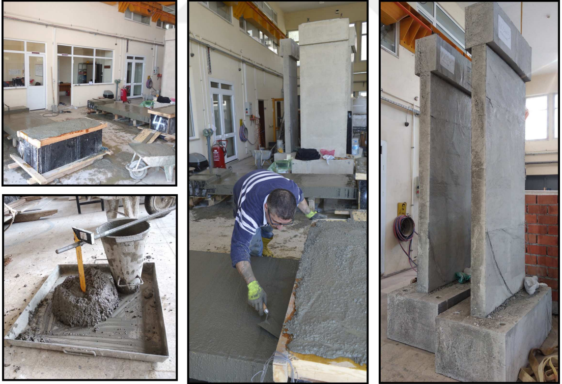
Şekil 3.13. Beton dökümü ve yüzey düzeltme işlemi ile deneye hazır üretilmiş numuneler
