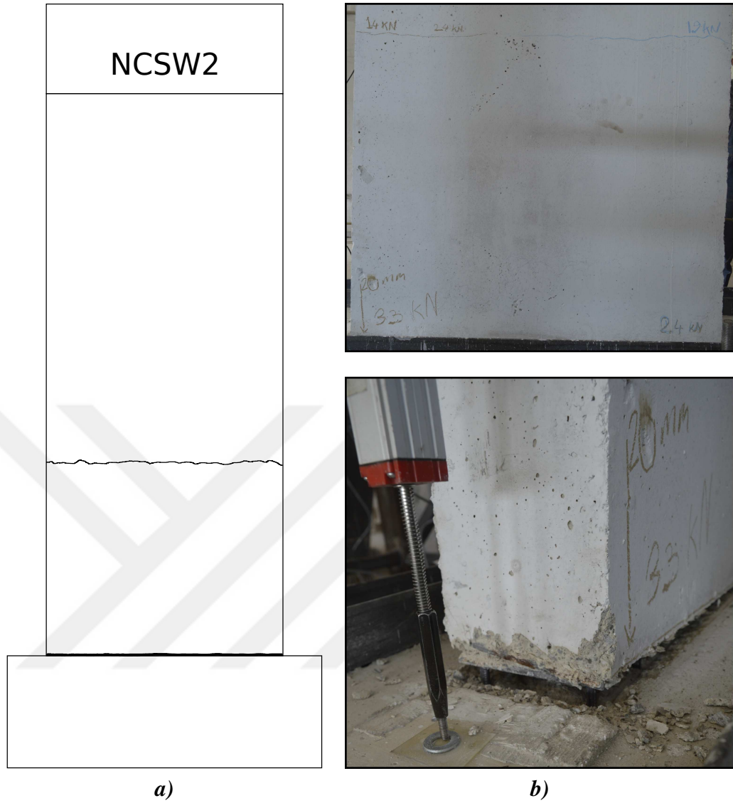
Şekil 4.8. a) NCSW2 deney numunesinin a) hasarın şematik gösterimi ve b) örnekleri
