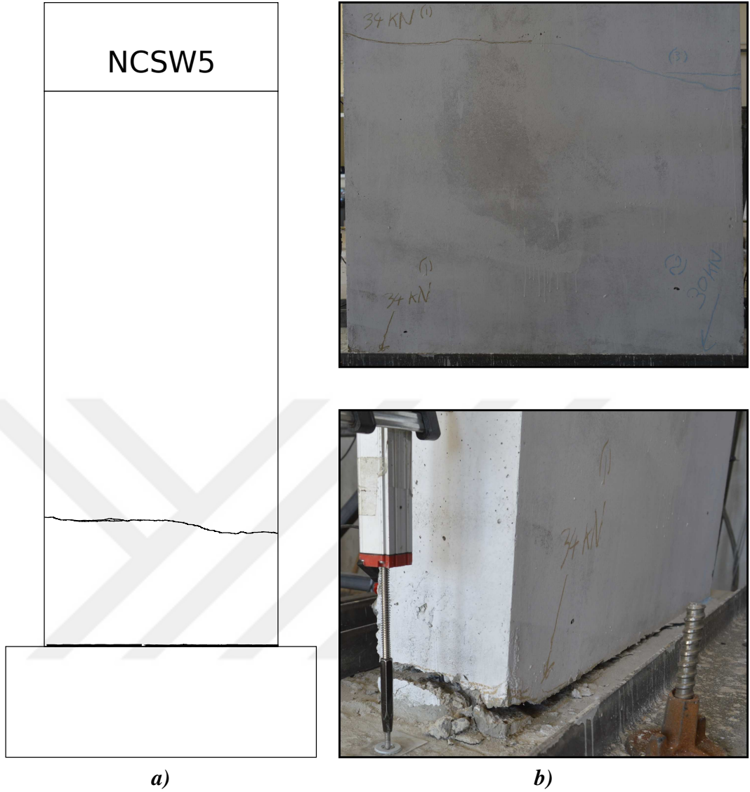
Şekil 4.17. a) NCSW5 deney numunesinin a) hasarın şematik gösterimi ve b) örnekleri
