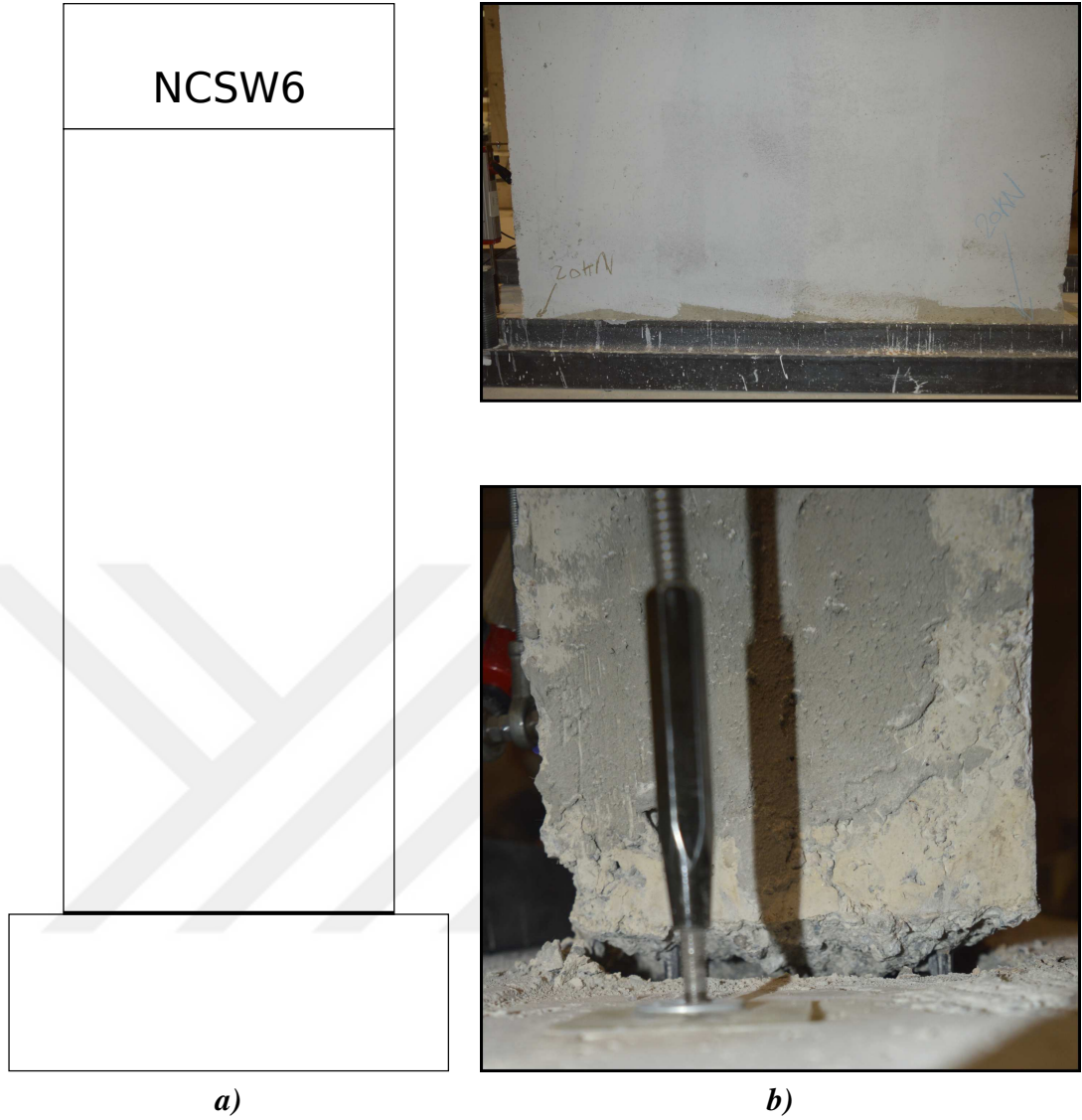
Şekil 4.20. a) NCSW6 deney numunesinin a) hasarın şematik gösterimi ve b) örnekleri
