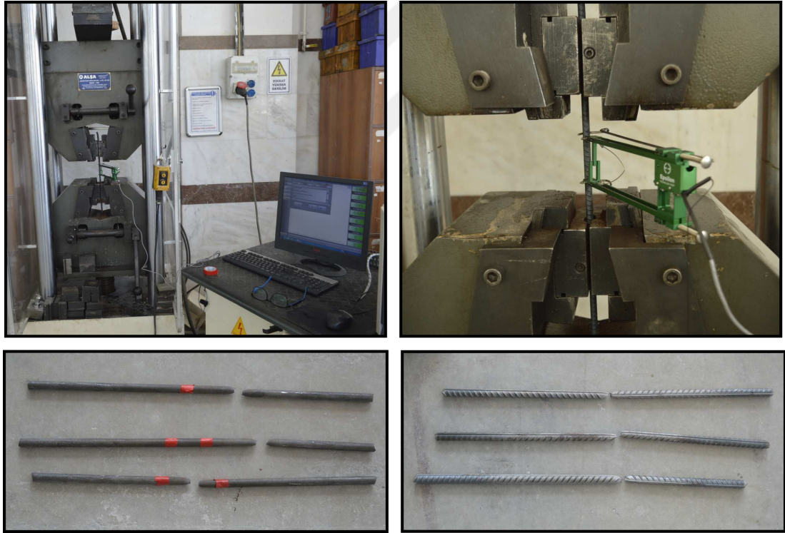
Şekil 3.14. Donatı çekme deneylerinden bir görünüm
