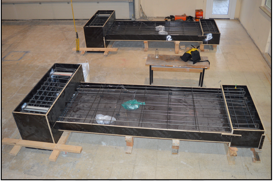
Şekil 3.12. Beton döküm işlemine hazır deney numuneleri
