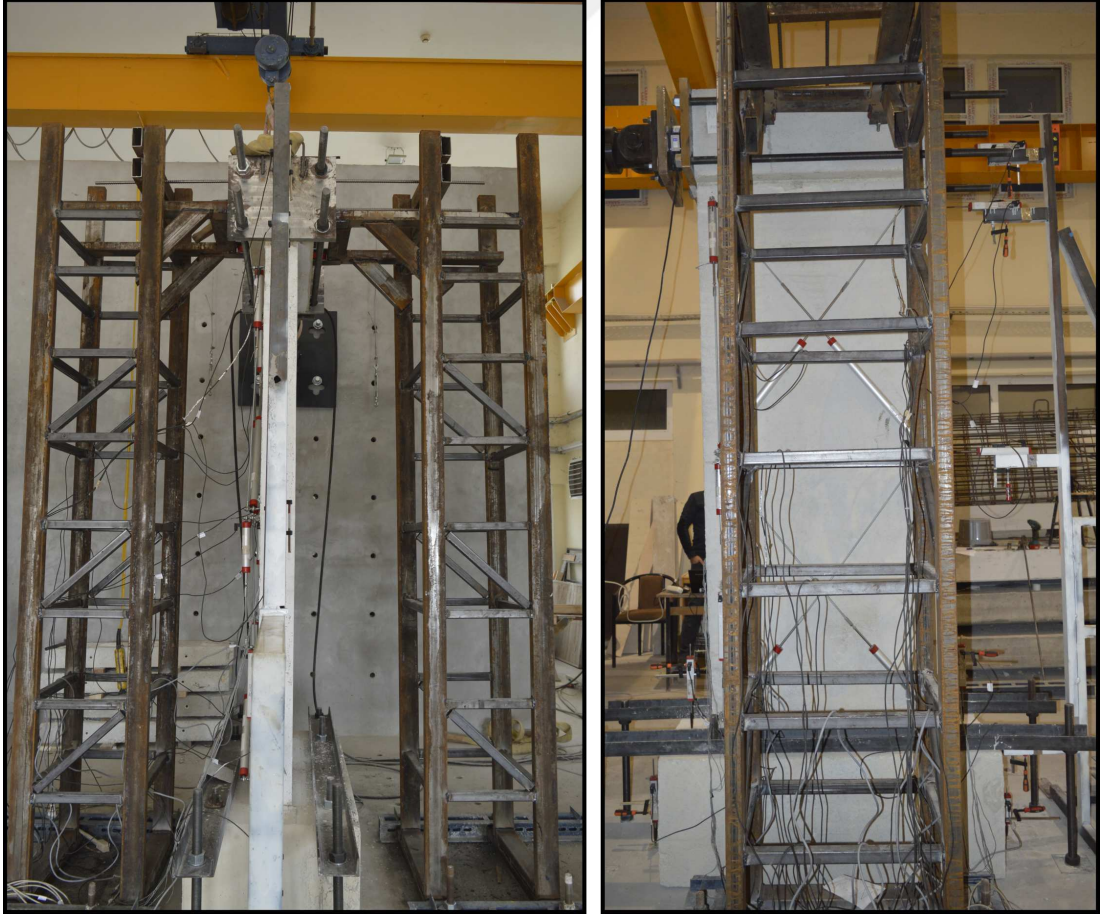
Şekil 3.19. Deney düzeneği düzlem dışı destek çerçevesi
