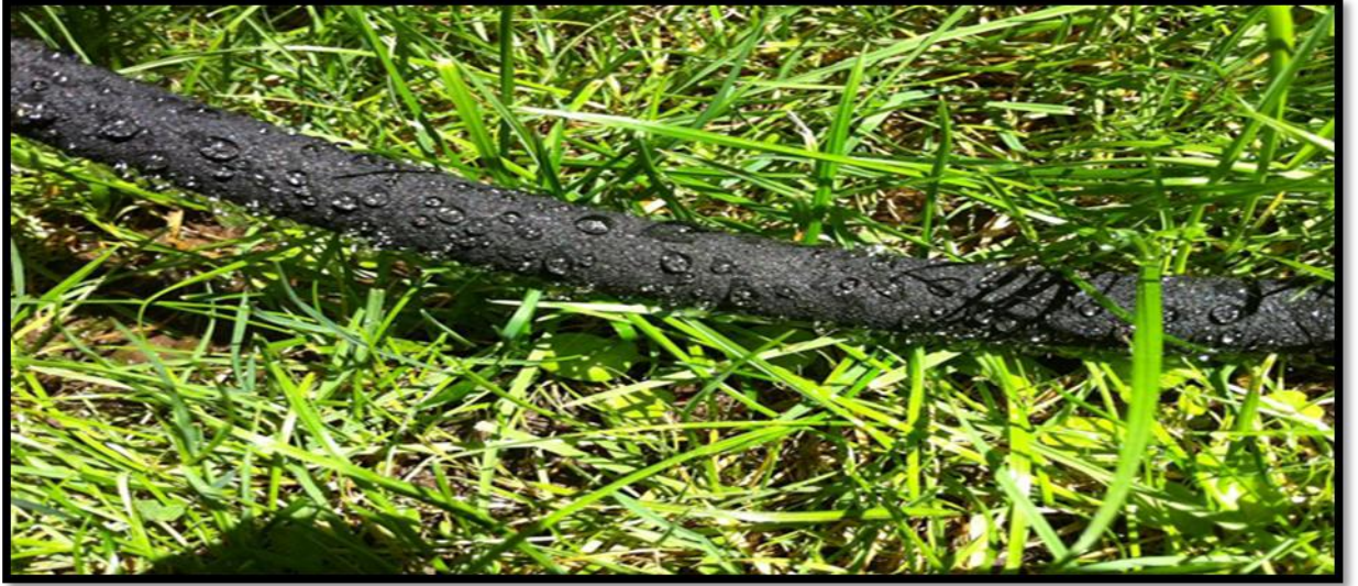
Şekil 1.35. Dikey bahçelerde terleyen boru sulama örneği (Anonim, 2020ş).
