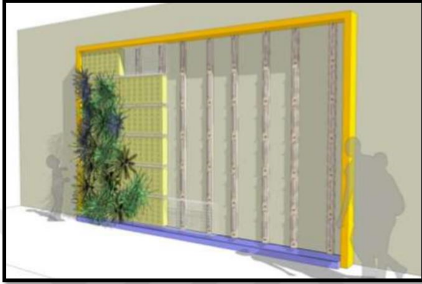
Şekil 1.20. Köpük tabanlı sistem uygulama simülasyonu (Anonim, 2020k).
