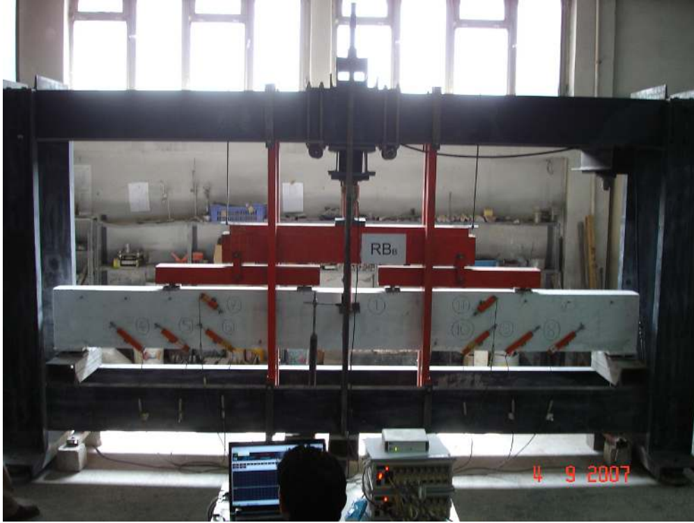
Resim 4.3. RBb kirişı deney öncesi görüntüsü
