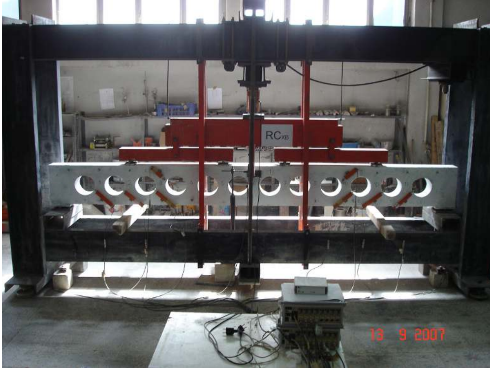
Resim 4.17. RCxb kirişı deney öncesi görüntüsü
