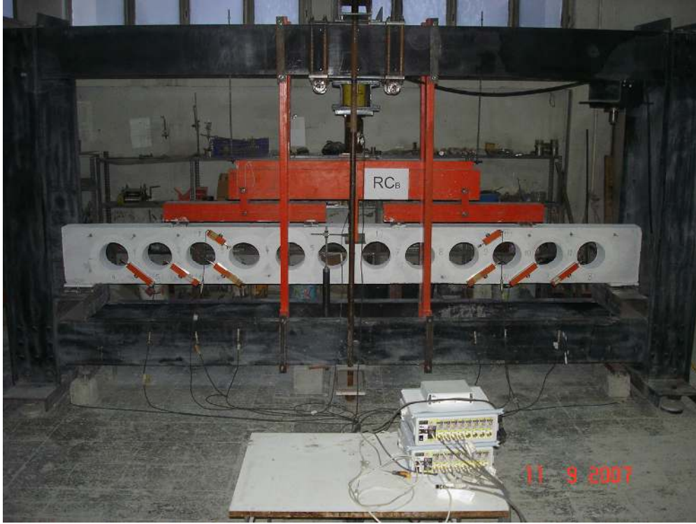
Resim 4.13. RCb kirişi deney öncesi görüntüsü
