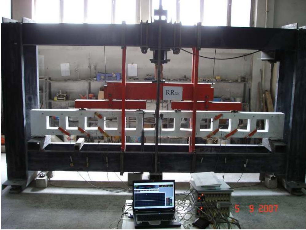
Resim 4.5. RRxn kirişi deney öncesi görüntüsü
