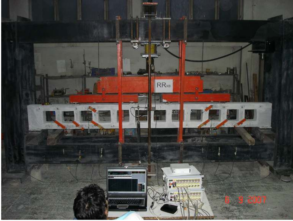
Resim 4.9. RRxb kirişı deney öncesi görüntüsü
