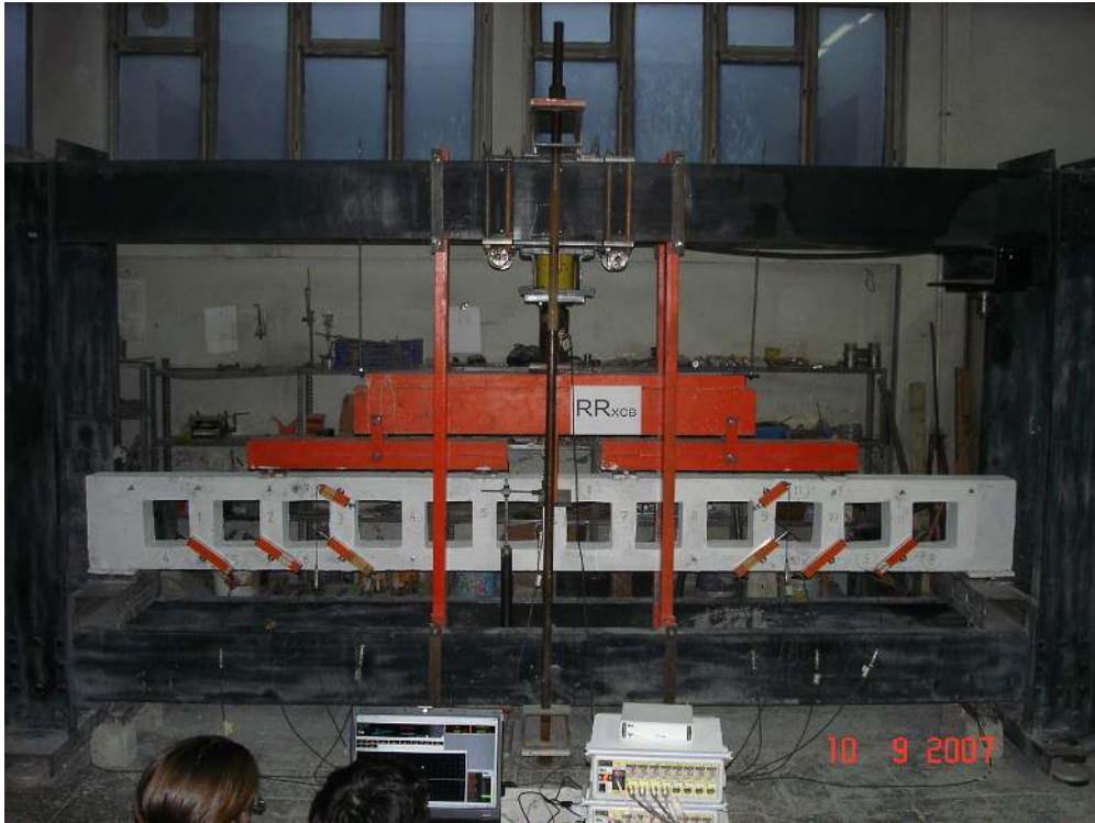
Resim 4.11. RRxcb kirişi deney öncesi görüntüsü
