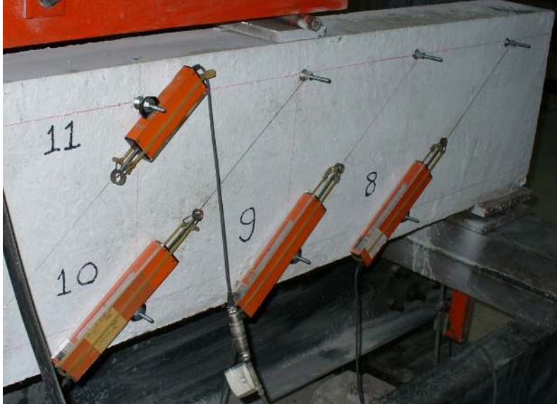
Resim 4.3. Kiriş üzerinde LVDT yerleşimi
