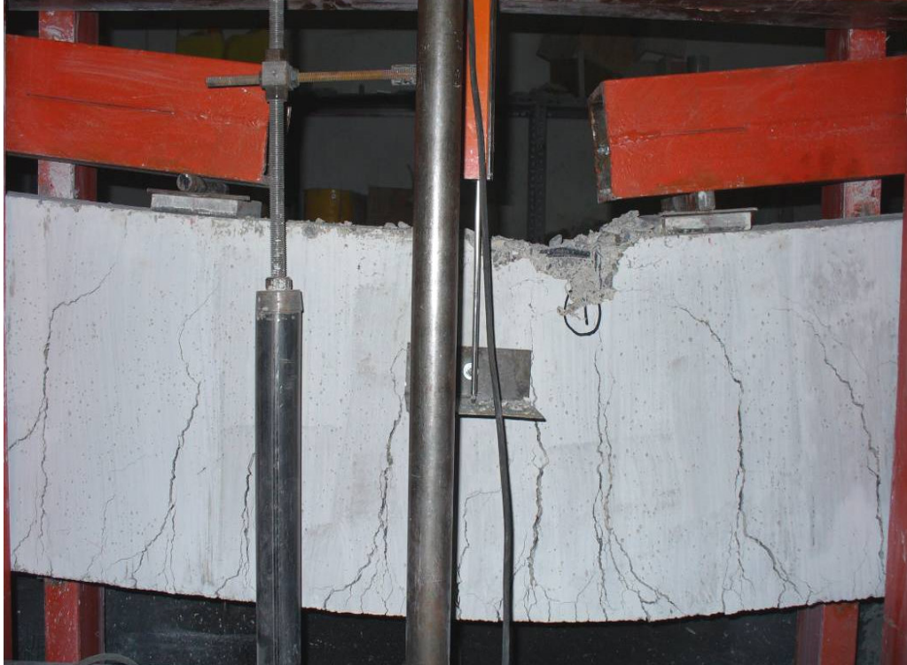
Resim 5.4. B_N kirişinde ezilme görüntüsü
