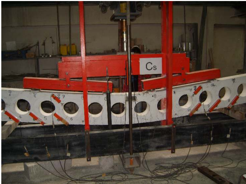
Resim 5.6. Cs kirişinin deney sonrası görüntüsü
