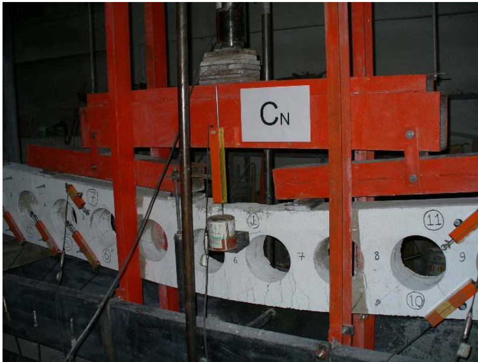
Resim 5.10. C_N kirişinin deney sonrası görüntüsü
