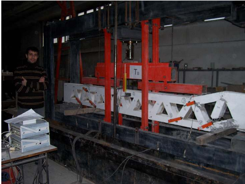
Resim 5.18. T B kirişinin deney sonrası görüntüsü
