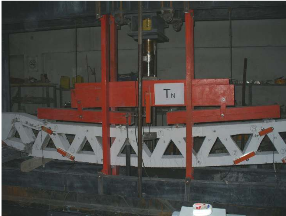
Resim 5.12. T_N kirişinin deney sonrası görüntüsü
