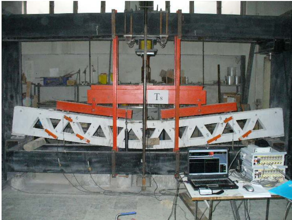
Resim 5.4. Ts kirişinin deney sonrası görüntüsü
