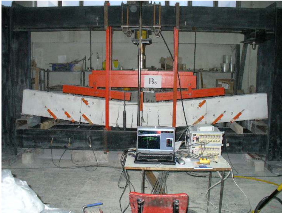
Resim 5.2. Bs kirişinin deney sonrası görüntüsü
