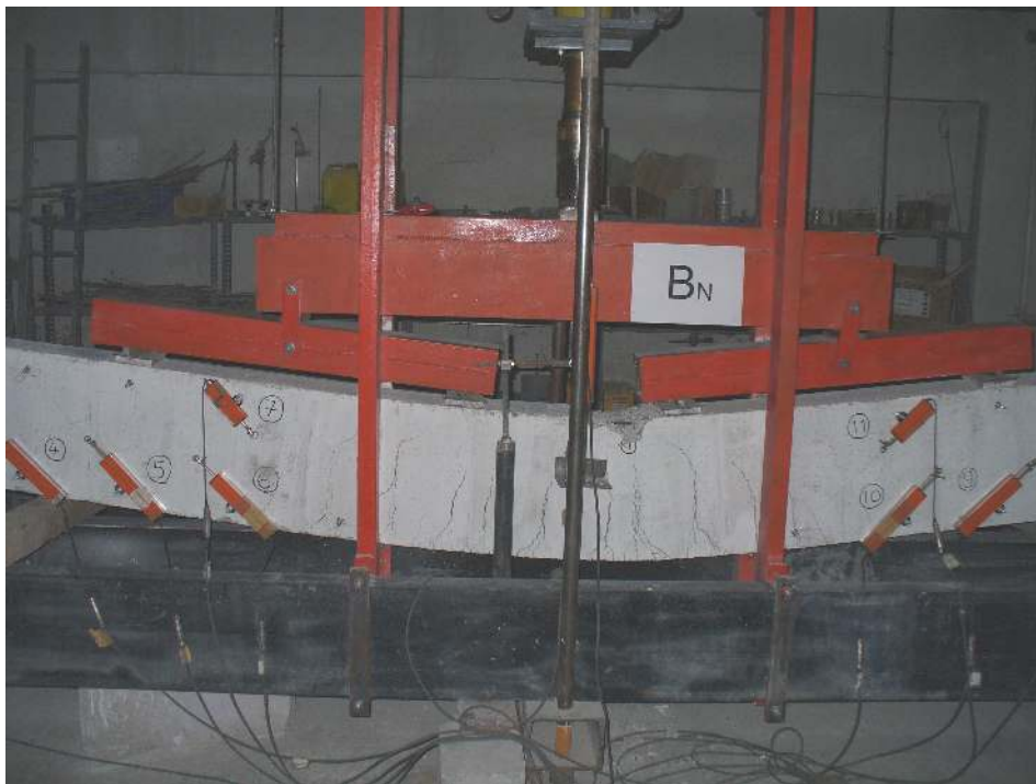
Resim 5.8. B_N kirişinin deney sonrası görüntüsü
