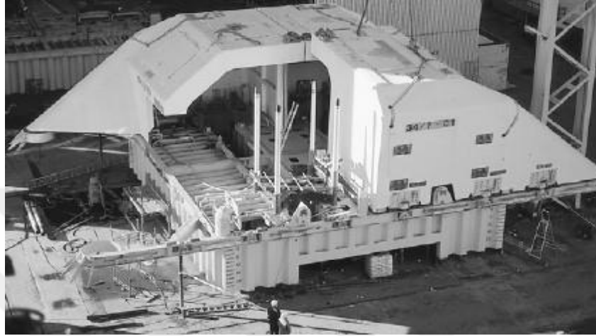
Şekil 2.13. Denizaltı muhafazası (Zenkert, 1997)
