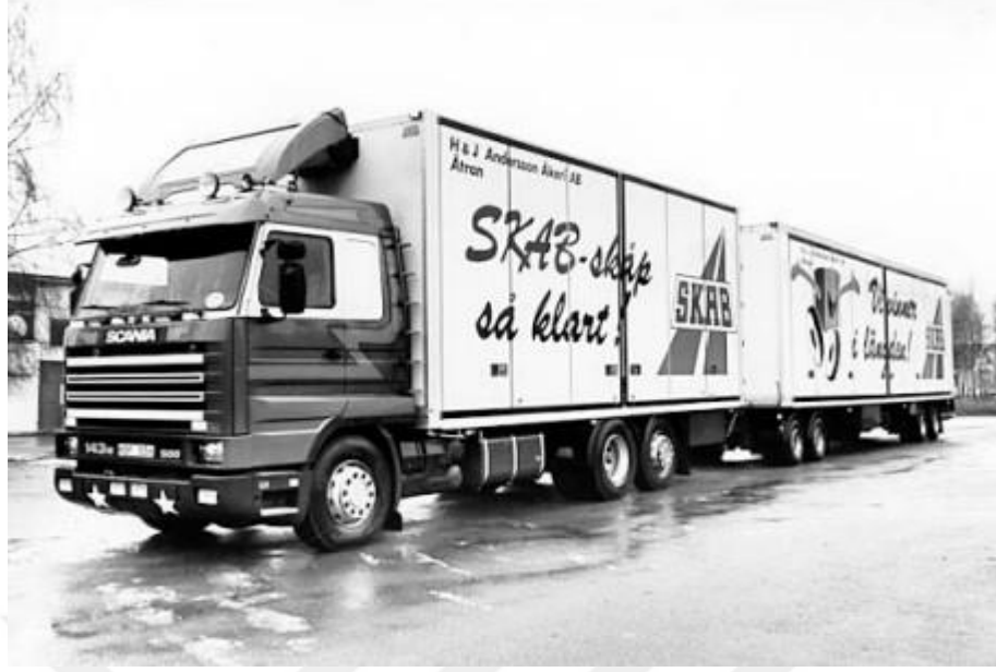
Şekil 2.9. Sandviç kompozit kamyon kasa yapısı (Zenkert, 1997)
