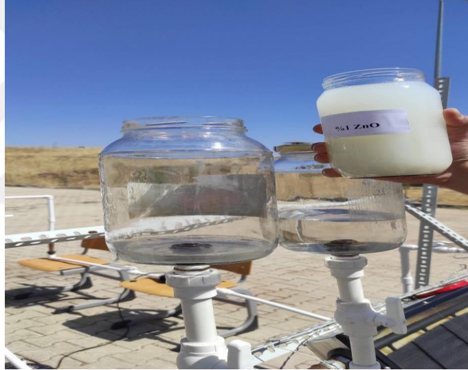
Şekil 3. 15 Deney düzeneğinde kullanılan ZnO-su nanoakışkanı
