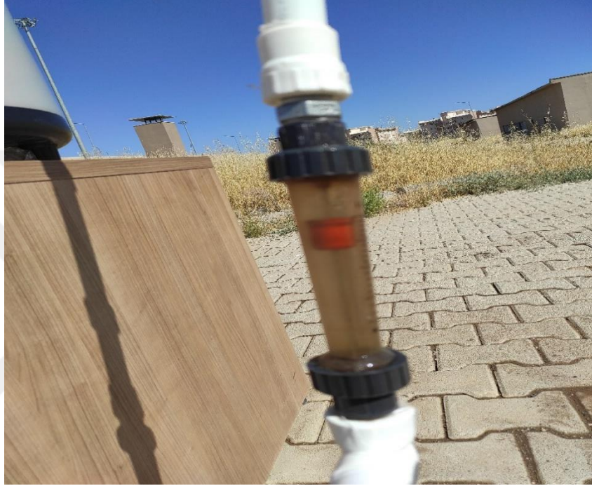
Şekil 3. 8 LZS 101 model şamandıralı debimetre
