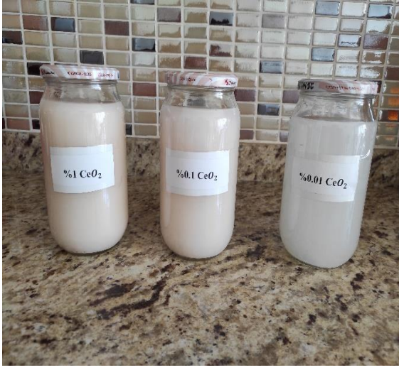
Şekil 3. 14 Deney düzeneğinde kullanılan CeO 2 -su ve ZnO-su nanoakışkanları
