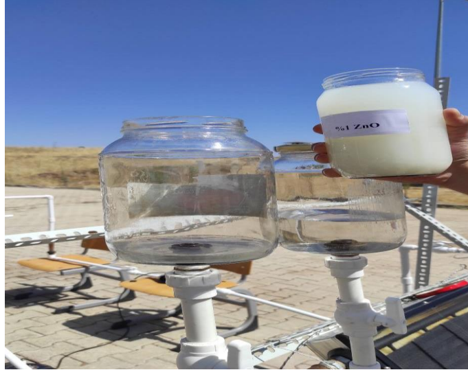
Şekil 3. 15 Deney düzeneğinde kullanılan ZnO-su nanoakışkanı
