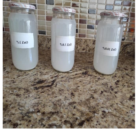
Şekil 3. 14 Deney düzeneğinde kullanılan CeO 2 -su ve ZnO-su nanoakışkanları
