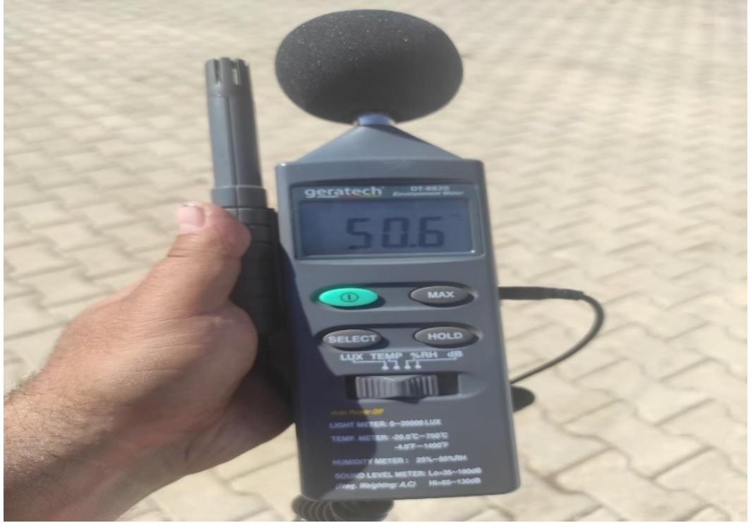
Şekil 3. 12 Geratech DT 8820 çok fonksiyonlu ölçüm cihazı
