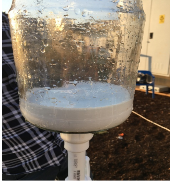
Şekil 3.13. Kollektöre eklenen TiO_2 - su nanoakışkanı
