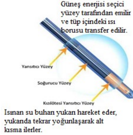
Şekil 1.23. Vakum tüplü kollektörün çalışması
