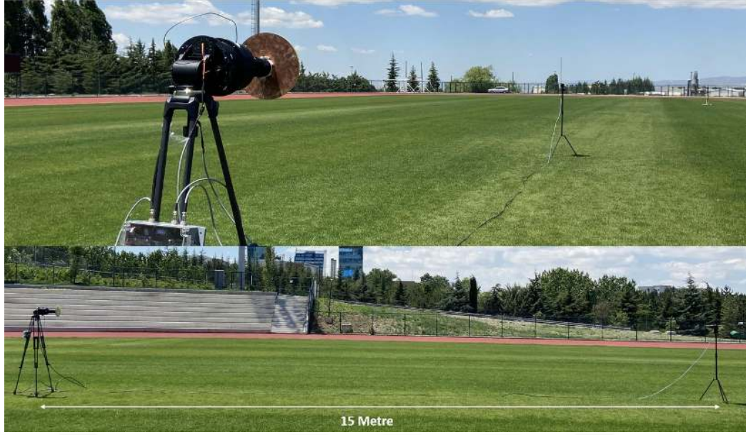
Şekil 34. Açık alan anten ölçüm düzeneği.
