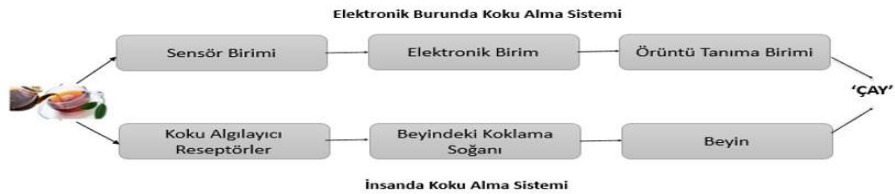
Şekil 7. İnsan burnu ve elektronik burun koku alma sistemi
