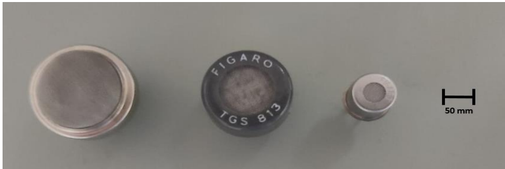
Şekil 19. Büyük ve küçük boyutlu TGS sensörler
