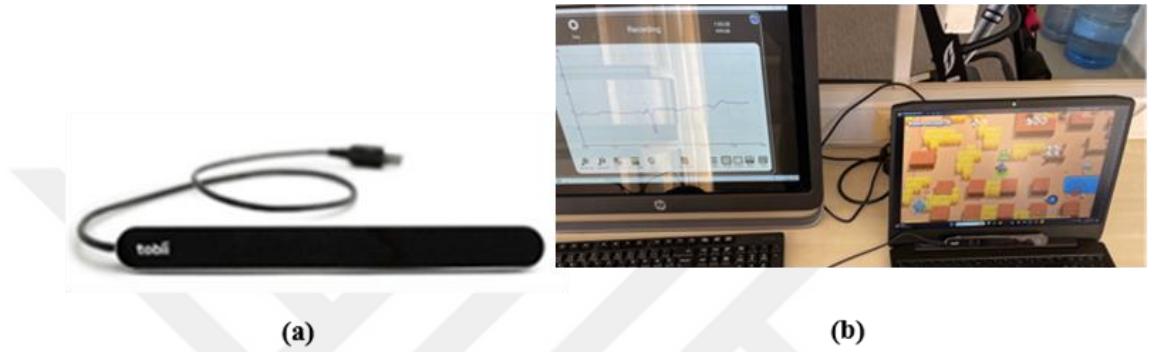
Şekil 3.3. a) Tobii Dynavox PCEye mini göz takip cihazı (Tobii Resmi Stesi); b) Göz takip cihazı ile e-spor oturumunda verilerin alınması
