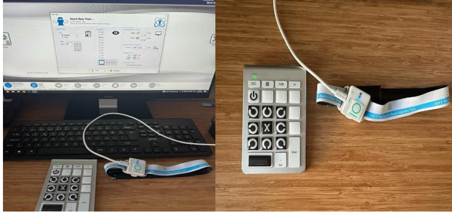
Şekil 2.5. f-HIT sistem içeriği; yazılımı içeren bilgisayar, ekran, mini klavye ve jireskop içeren baş bandı
