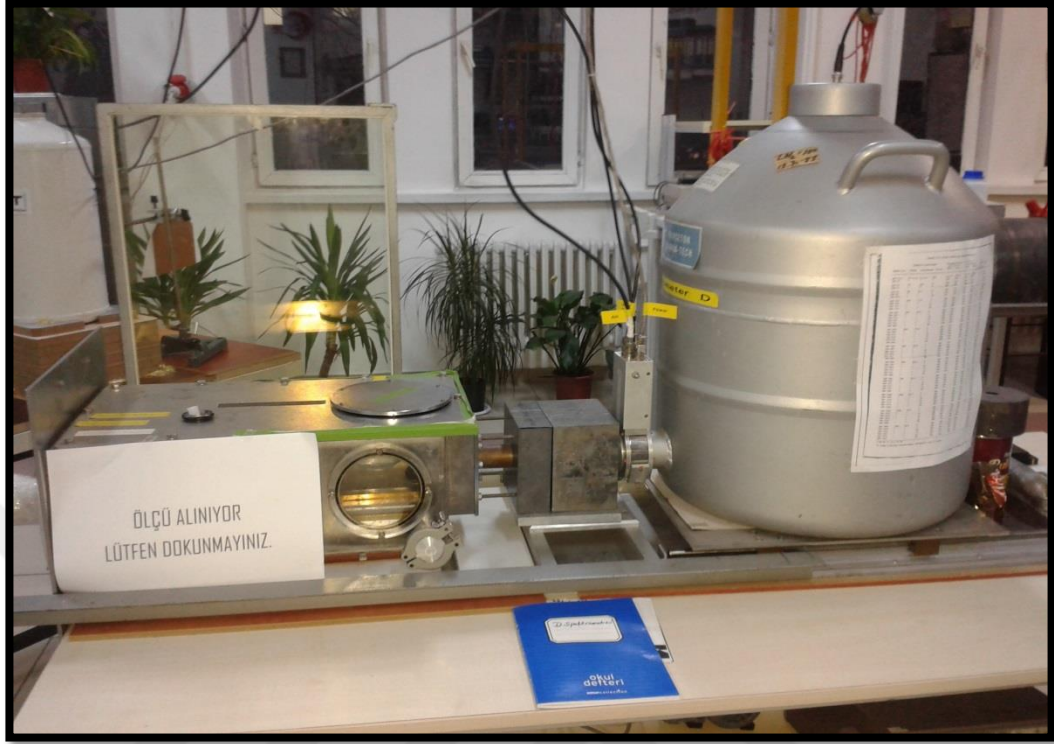
Şekil 3.11. HPGe dedektör ile tasarlanmış deney sistemi.
