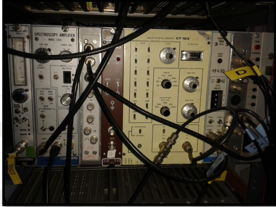
Şekil 3.5. Deney sisteminde kullanılan NIM ünitesinin bir bölümü.
