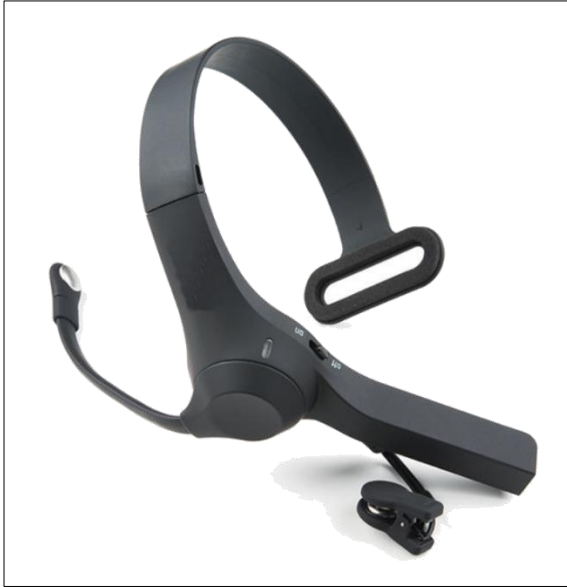
Şekil 34. Bir elektrotlu NeuroSky MindWave Mobile2 beyin dalga sinyal algılayıcı (URL-23, 2024).
