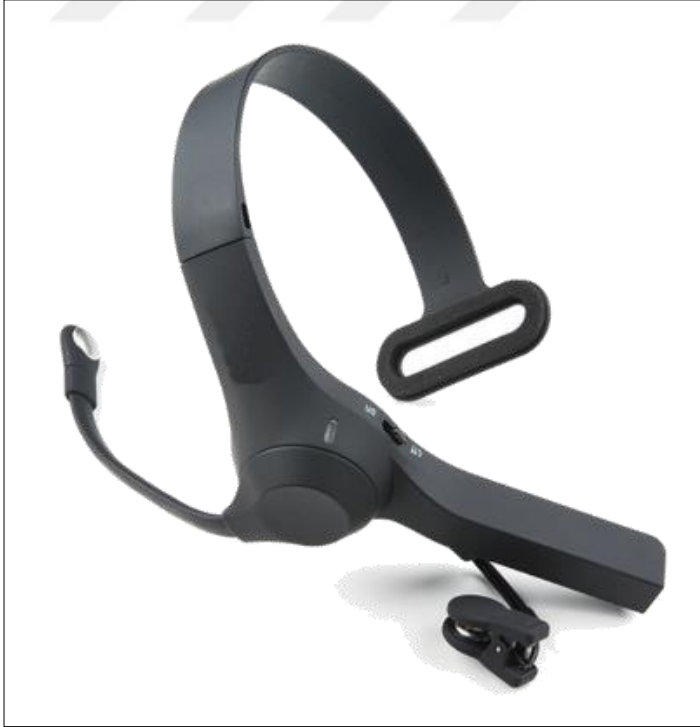
Şekil 30. Tek elektrotlu beyin dalga sinyal alıcı sensörü (URL-23, 2024)
