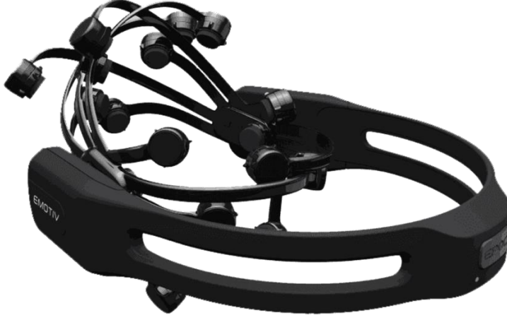
Şekil 26. Çoklu elektrotlu kablosuz beyin sinyal alıcı sensör (URL-21, 2024)
