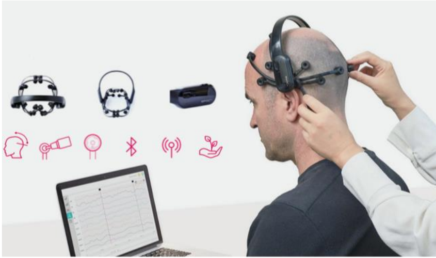
Şekil 21. 14 kanal (AF3, F7, F3, FC5, T7, P7, O1, O2, P8, T8, FC6, F4, F8, AF4) elektrotlu kablosuz beyin sinyal algılama cihazı takılışı (URL-16, 2023)
