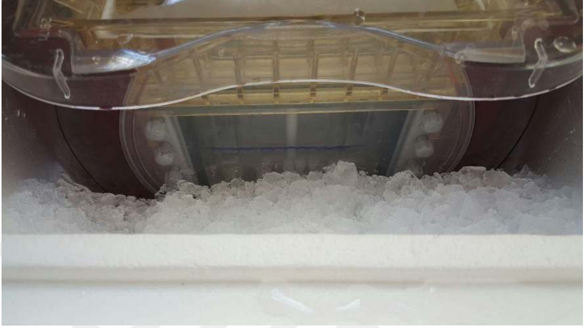
Şekil 3.7. Buz dolu köpük kutu içinde elektroforez basamağındaki yürütme tankı
