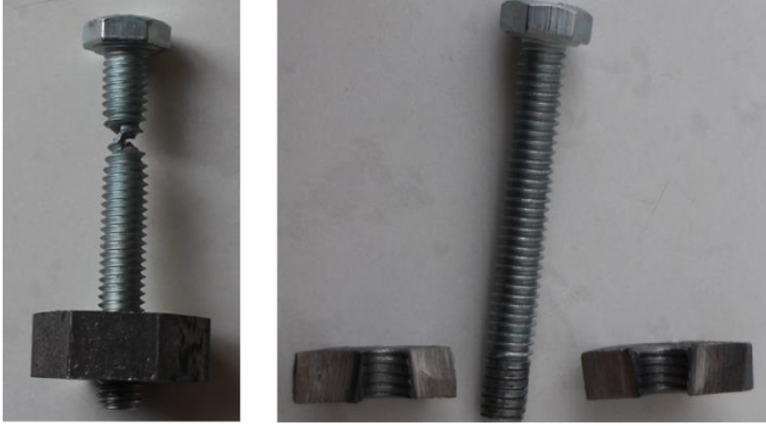
Şekil 2.12: Civatanın koptuğu ve dişlerin hasar gördüğü testler.
