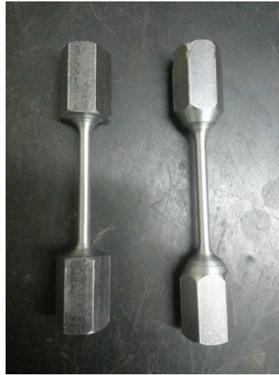
Şekil 2.4: 5mm çaplı numuneler.
