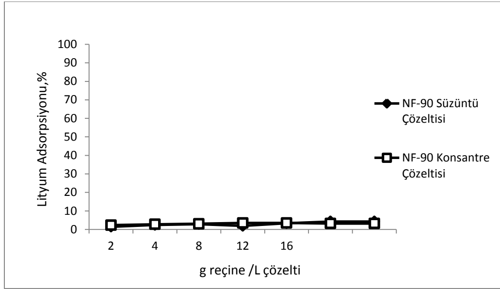
Şekil 4.23. Diaion CRB-02 reçinesi ile NF-90 membranının süzüntü ve konsantre çözeltilerinden lityum ayrılması
