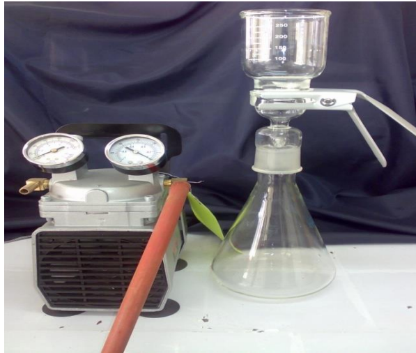
Şekil 2.12. Filtrasyon hunisi, destek bağlantısı, filtrasyon erleni, basınç/vakum pompası
