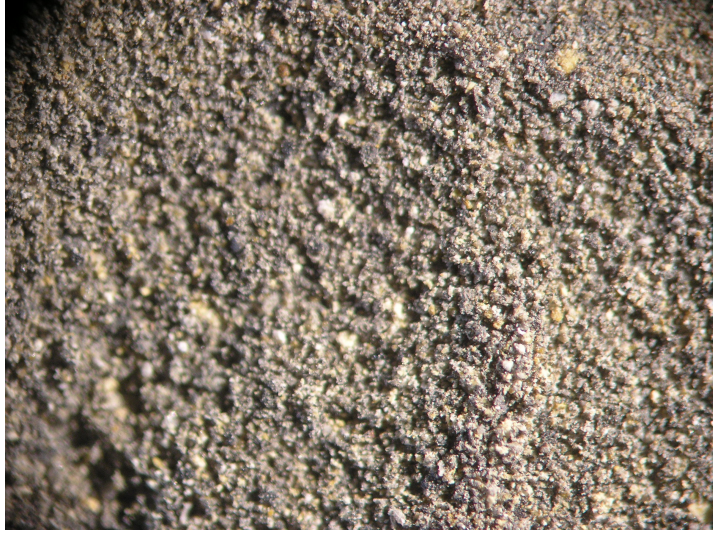
Şekil 4.1 Soma kül numunelerinin mikroskopik görünüşü (30 kat büyütme)
