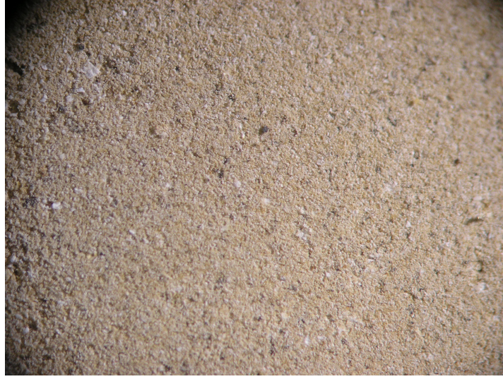
Şekil 4.3 Yeniköy kül numunelerinin mikroskopik görünüşü (30 kat büyütme)
