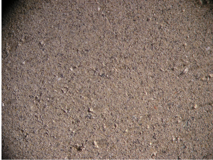
Şekil 4.2 Yatağan kül numunelerinin mikroskopik görünüşü (30 kat büyütme)
