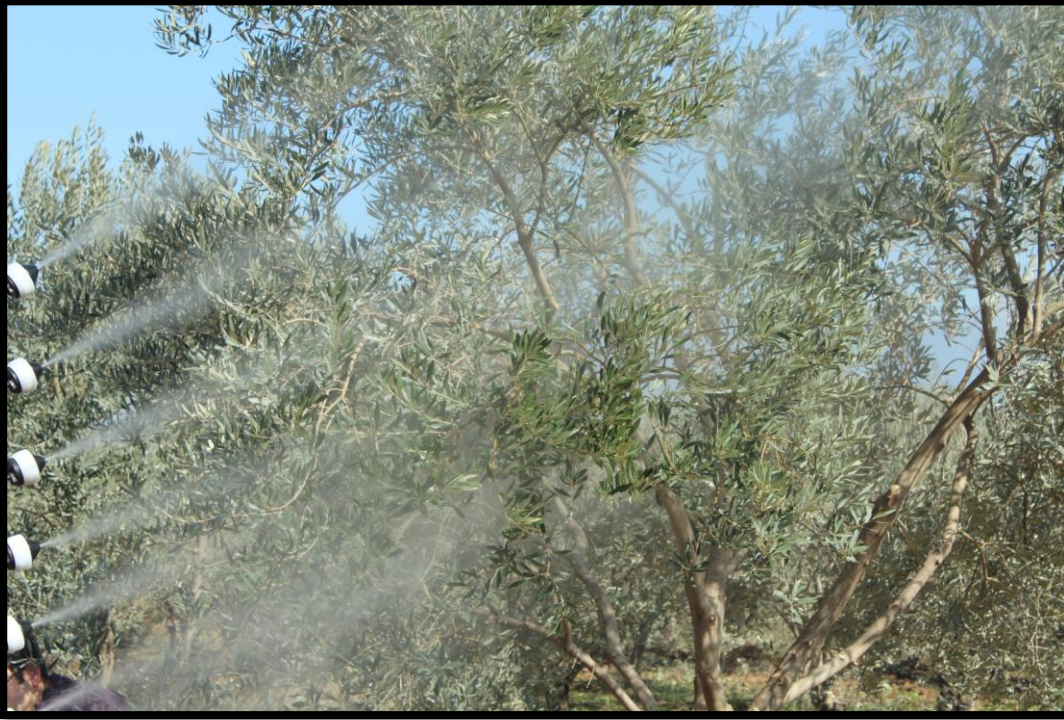
Şekil 4.5 Deneme bahçemizde 80 SR elektrostatik ilaçlama makinası ile püskürtme sırasında memelerden eksi yüklü damlacıkların çıkışı.
