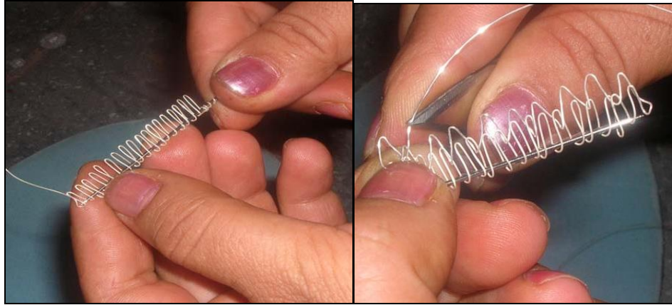
Resim 28: Trabzon hasırının hazırlanma aşamaları. Kaynak: http://hbogm.meb.gov.tr/modulerprogramlar/kursprogramlari/kuyumculuk/moduller/hasir_orme.pdf .
