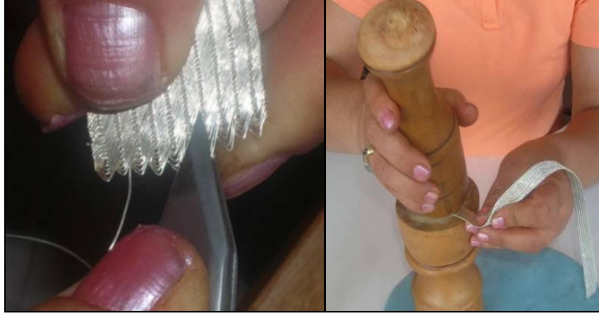
Resim 29: Hasırın çift ile düzeltilerek ütülenmesi işlemi. Kaynak: http://hbogm.meb.gov.tr/modulerprogramlar/kursprogramlari/kuyumculuk/moduller/hasir_orme.pdf .
