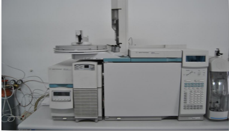
Fotoğraf 2.4. Tez kapsamında kullanılan GC (Agilent 6890 N)-MSD (Agilent 5973 inert MSD) cihazı (orijinal).
