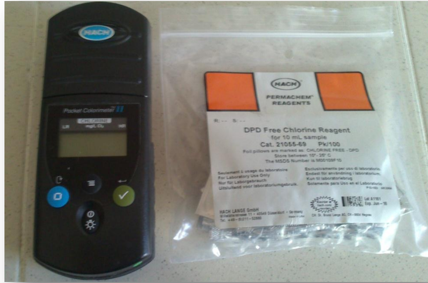
Fotoğraf 2.6. Tez kapsamında numune alma noktasında ölçümü yapılan bakiye klorun ölçümünü gerçekleştiren pocket colorimeter II (Hach) cihazı. (orijinal)
