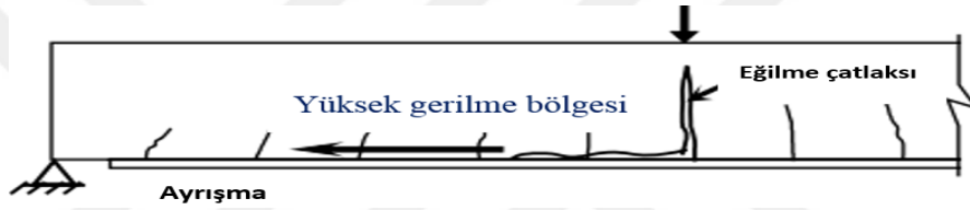
Şekil 2.8. Güçlendirilmiş kirişte plak uç delaminasyonu
