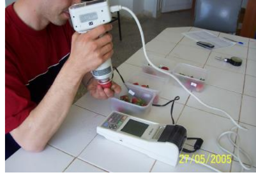
Şekil 3.14. Meyve Dış Renginin Kromometre ile Belirlenmesi
