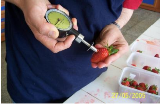
Şekil 3.13. Meyve Sertliğinin Penetromotre ile Belirlenmesi
