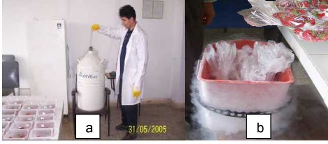
Şekil 3.15. Meyvelerin Sıvı Azotla Dondurulması (a: Sıvı Azot Tankında, b: Kovada)
