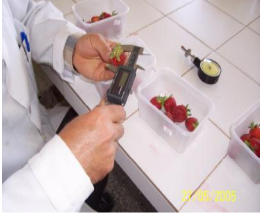
Şekil 3.11. Meyve boyutlarının Dijital Kumpas ile Ölçülmesi
