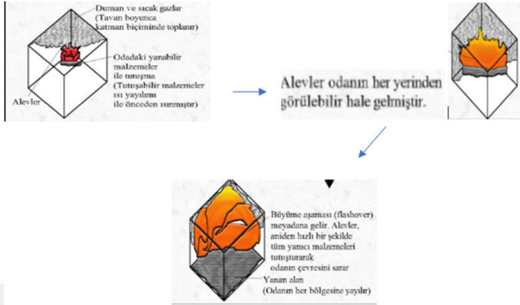
Şekil 1.6 Yangının büyüme aşaması (İplikçi, 2006)
