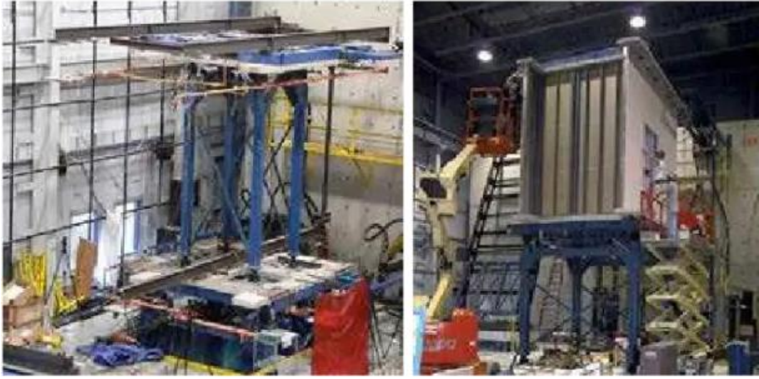
Şekil 1.1. SUNY Buffalo Üniversitesinde yapısal olmayan elemanlar simülatorü (İpek, 2015).
