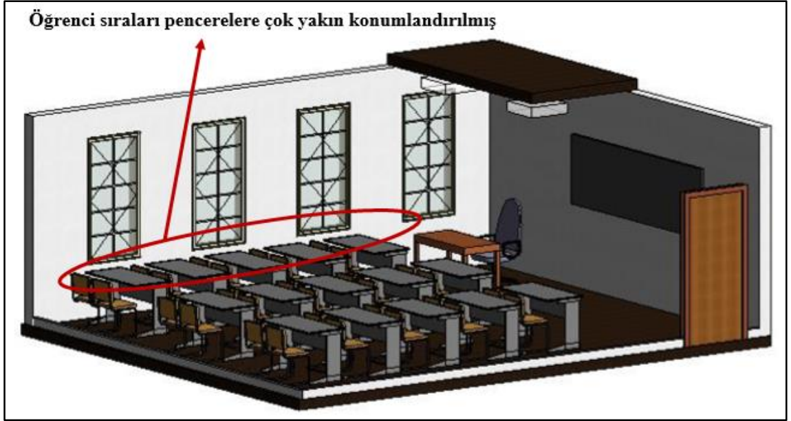
Şekil 6.7. Sınıflarda bulunan öğrenci sıralarının konumlarının mimari çizimi.
