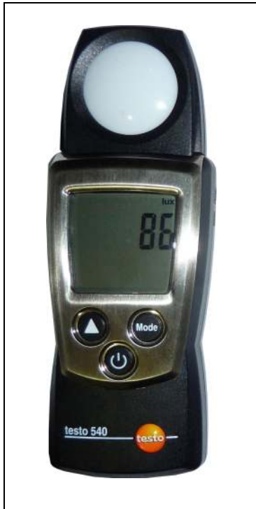
Resim 4.1. ISO kalibrasyon sertifikalı ışık ölçer Testo/540
