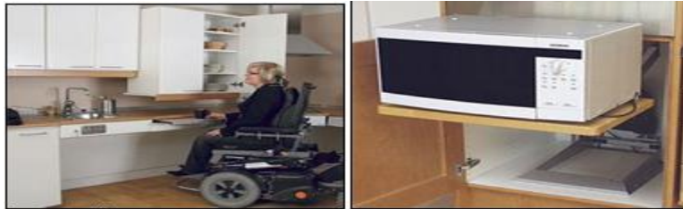
Resim 2. Hareketli Üst Dolap Uygulaması, Çekmeceli Tezgâh ve Elektrikli Gereçlerin Düzenlenmesi
